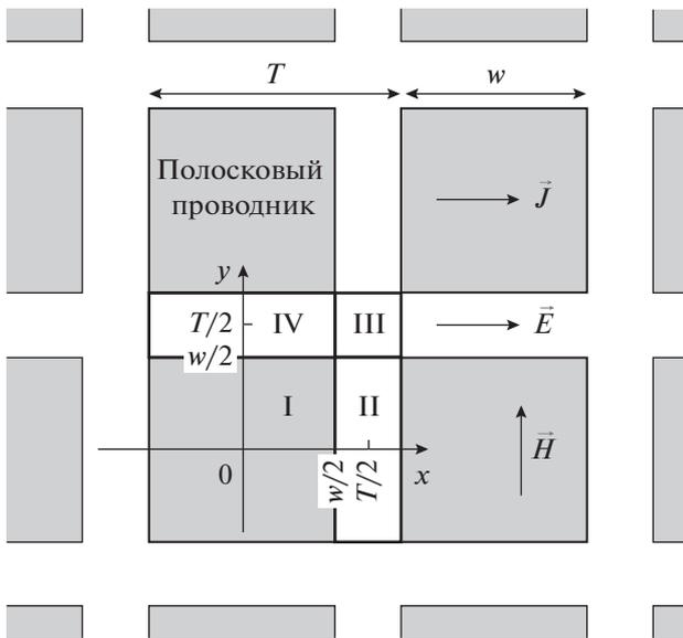
Рис. 1. Решетка полосковых проводников; I, II, III и IV – рассматриваемые участки ее элементарной ячейки.
