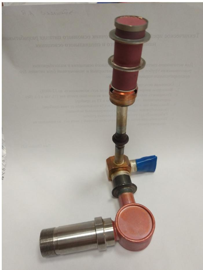
Рис.2. Вид рабочего прототипа рентгеновской трубки с автокатодом
