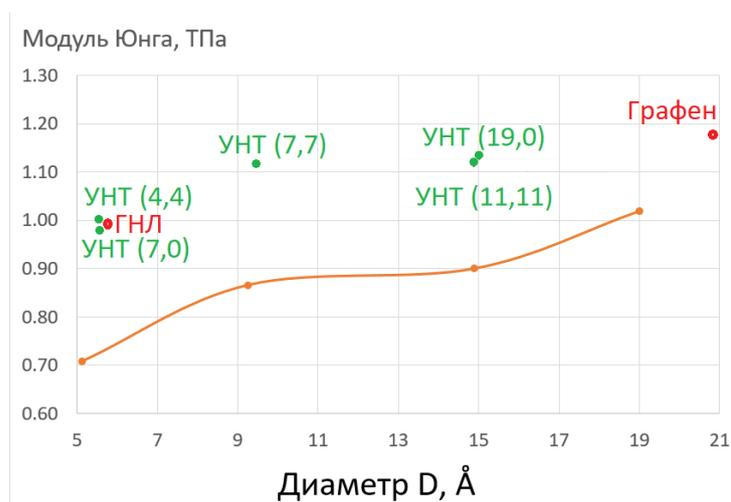
Рис. 3. Модули Юнга углеродных структур
