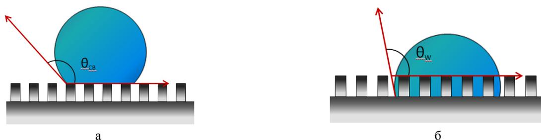
Рис. 1. (а) Состояние Касси; (б) состояние Венцеля
