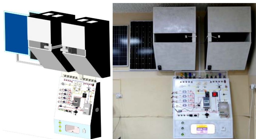
Рис. 1. Трехмерная модель (слева) и фотография стенда «Испытание солнечных панелей» (справа)
