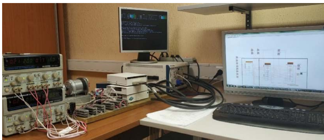
Рис. 3. Лабораторный комплекс для исследования и отладки законов управления ИДДП
