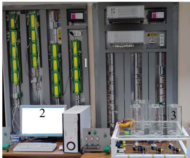
Рис. 3. Прототип платформы: 1 – программируемый логический контроллер TREI 5B-05; 2 – рабочее место оператора; 3 – стенд платформы
