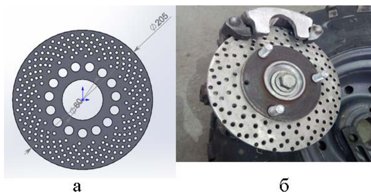
Рис. 7. Детали рабочего тормозного механизма: а – модель тормозного диска; б – тормозной механизм в сборе со ступицей колеса
