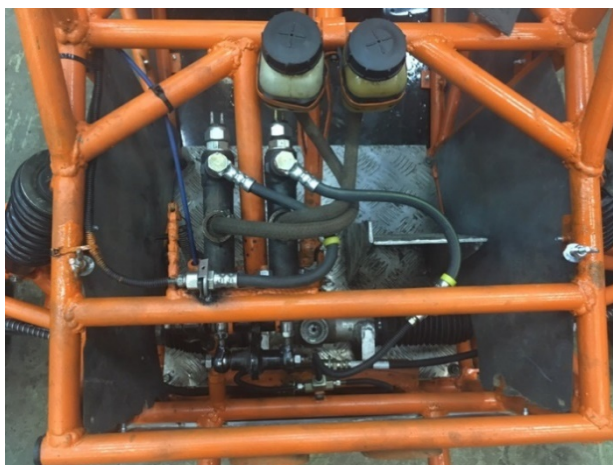
Рис. 6. Главные тормозные цилиндры(вид сверху).
