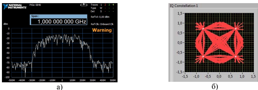
Рис. 2. Вывод результатов на экран: а – спектр сформированного сигнала; б – констелляционная диаграмма принятого сигнала
