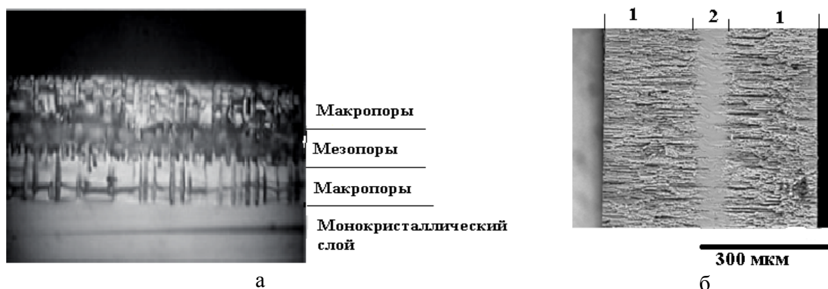
Рис. 1. Трехслойные структуры пористого кремния на монокристаллической пластине: 1 – макропористый кремний с пористостью \Pi_1 ; 2 – пористый кремний с пористостью \Pi_2 , причем \Pi_2 > \Pi_1
