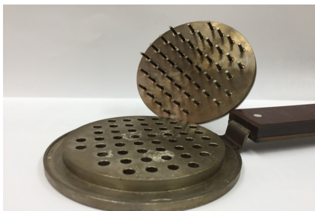
Рис. 2. Репликатор: ручка со штырьками (вверху) и станина с лунками (внизу)
