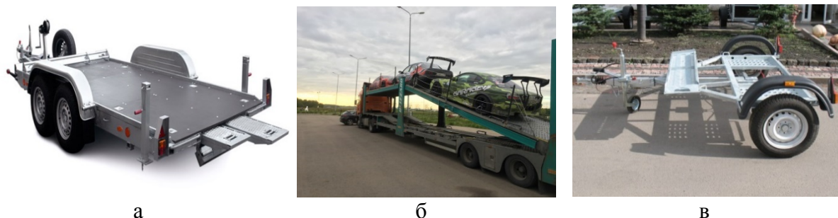
Рис. 1. Способы перевозки автомобилей: а – двухосный прицеп для полной погрузки; б – автовоз; в – прицеп одноосный для частичной погрузки.
