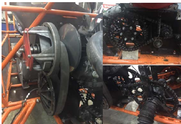
Рис. 9. Трансмиссия автомобиля Vaja Russia – “Belka”
