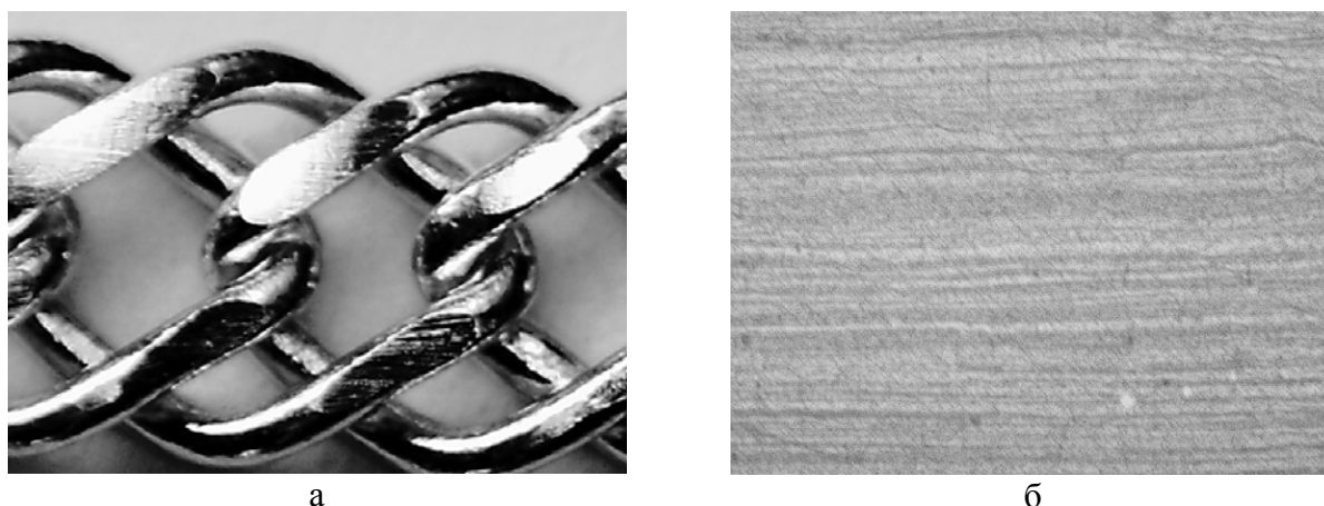
Рис. Вид ювелирной цепи «Ромб двойной» (а), микроструктура проволоки диаметром 0,25 мм (б), \times 200
