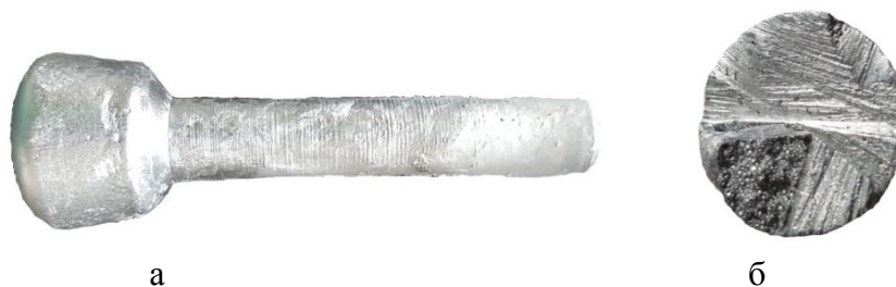
Рис. Образец пеноалюминия: а – отливка; б – сечение образца со сколом
