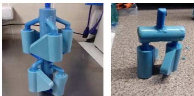
Рис. 2. Слева – восковая «Елка» с литниковой системой «Тип Центральный стояк», справа – «Тип Верхняя прибыль»
