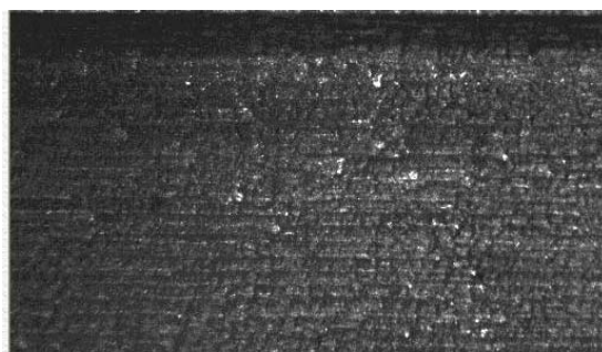
Рис. 2. Шероховатость поверхности при обработке пластиной CNMG 120404-EM
