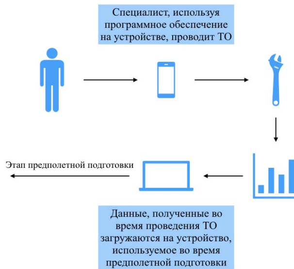
Рис. 2. Схема проведения ТО с использованием устройства для получения данных о состоянии систем
