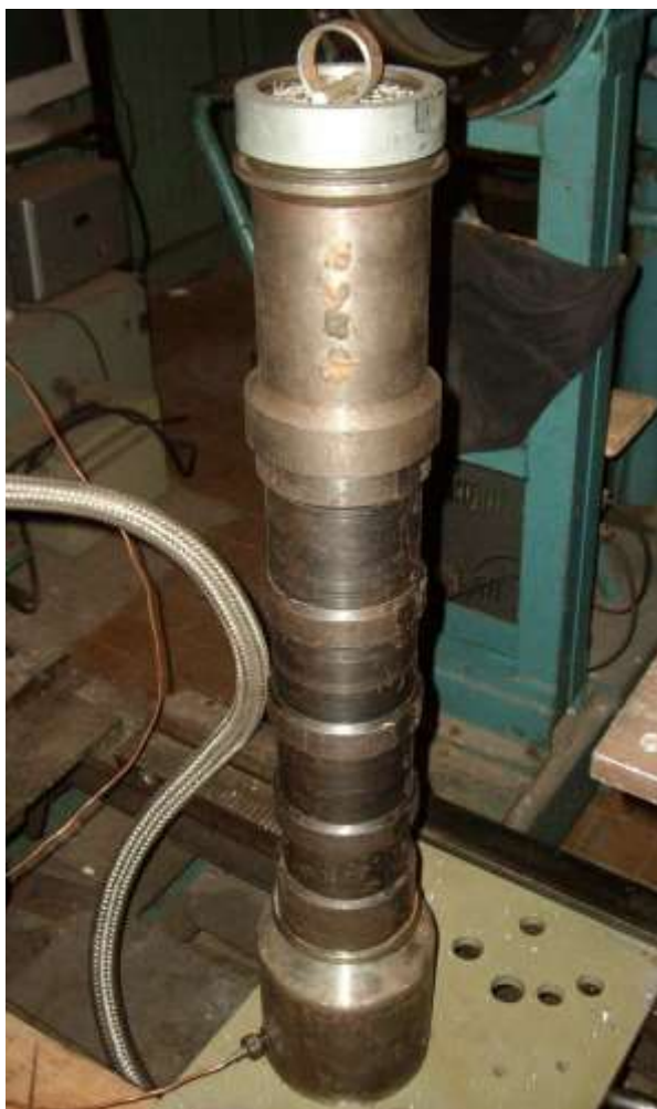
Рис. 1 – Газоимпульсная обработка кольца из никельсодержащего сплава
