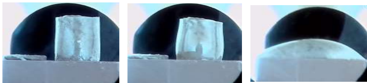
а) - начало плавления, 1150 °С б) – размягчение, 1250 °С в) растекание, 1300 °С
