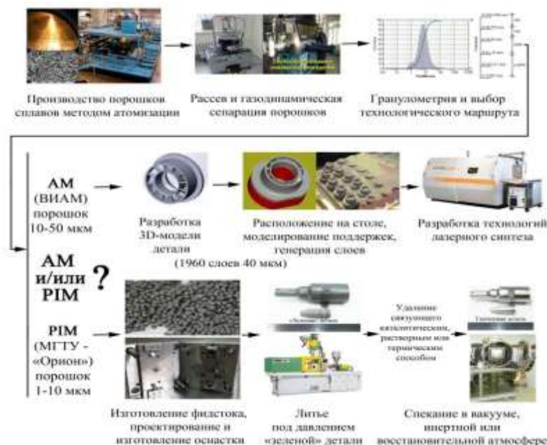
Рис. 5 – Два маршрута изготовления детали «Завихритель»
