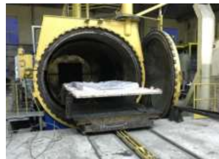
Рис. 7 – Загрузка «вакуумного мешка» в автоклав
