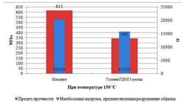
Рис. 9 – Диаграмма влияния натуральных климатических испытаний на предел прочности при сжатии и наибольшую нагрузку, предшествующую разрушению образца по ГОСТ 25.602-80
