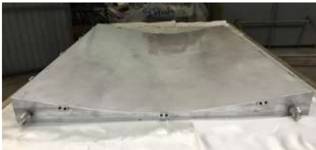
Рис. 4 – Технологическая матрица для изготовления фрагмента верхней обшивки крыла
