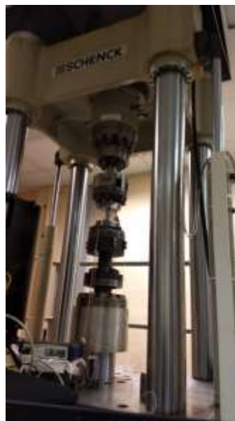
Рис. 2 – Сервогидравлическая испытательная установка POZ 0909 фирмы K.Schenck (Германия) с системой управления фирмы ViSS (Индия), макс. нагрузка 630 кН, макс. момент силы 8 кН·м
