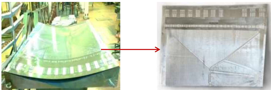
Рис. 8 – Формообразованная деталь из листа сплава В95очТ2, установленная на технологическую матрицу
