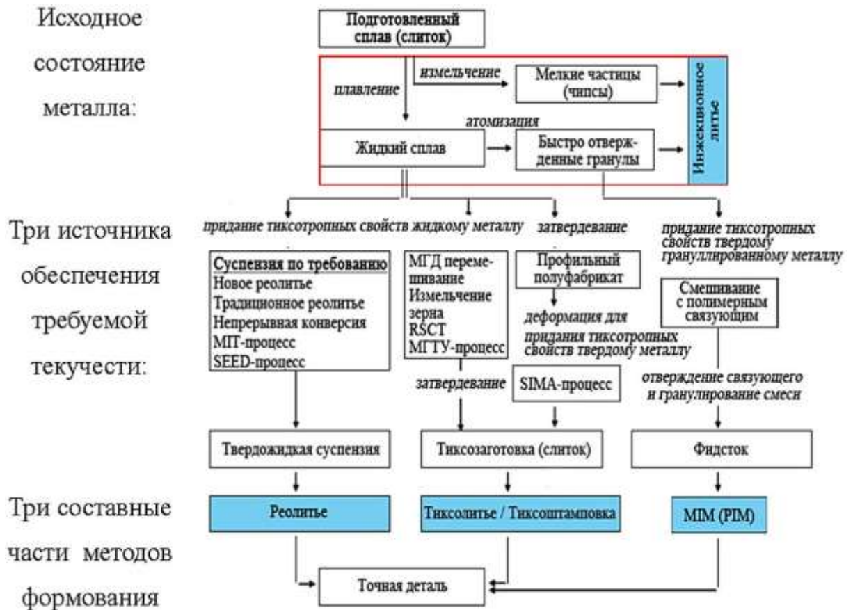
Рис. 2 – Процессы металлургии современных тиксотропных материалов
