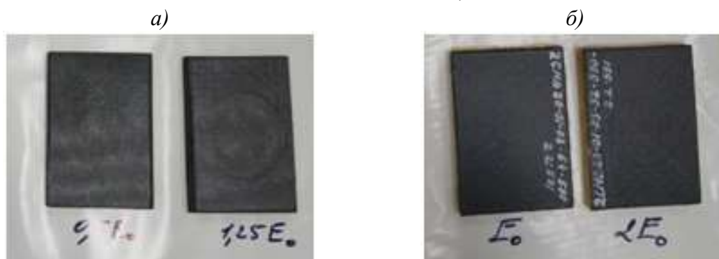
Рис. 7 – Вид образцов после ремонта
