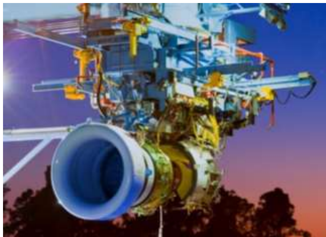
Рис. 7 – Наземные испытания двигателя Pure Power PW1524G [19]
