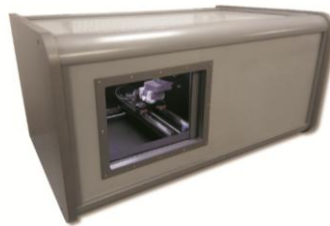
Рис. 1 Микрофокусный рентгеновский компьютерный томограф МРКТ-04.
