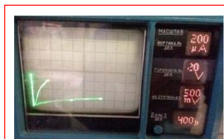
Рис.2. – Измерение тока утечки закрытого транзистора.
