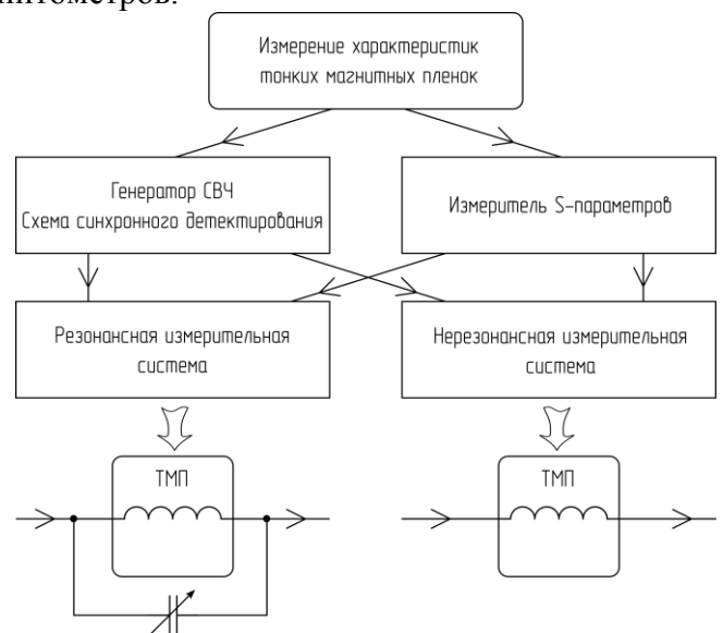
Рисунок 8 – Методы измерения интегральных магнитных характеристик ТМП
