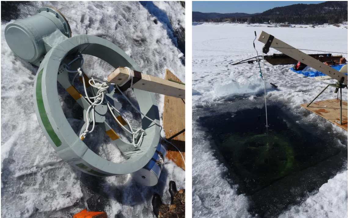
Рисунок Г.2 – Подготовка и погружение передатчика ближнепольной системы магнитной связи
