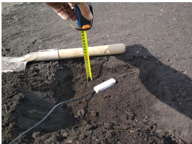
Рис. 3. Ход измерения профилей объемной влажности почвы на тестовом участке.
