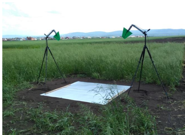
Рис. 7. Геометрия размещения логопериодических антенн. (На фотографии показан также лист фольгированного утеплителя, который использовался для калибровки в методике измерения коэффициента отражения).
