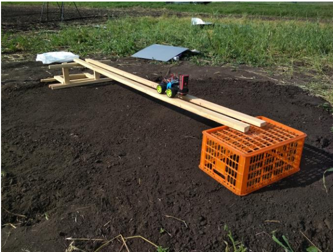
Рис. 1. Автоматическая платформа с направляющими в ходе измерения шероховатости поверхности почвы лазерной рулеткой.
