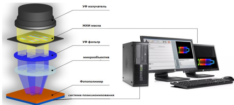
Рис. 4. Структура классической 2D системы безмасочной некогерентной стереолитографии
