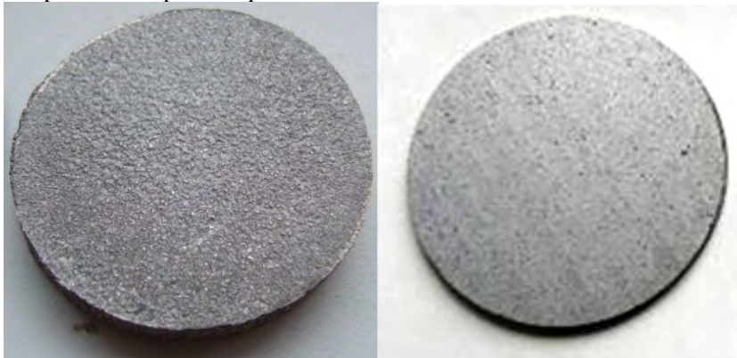
Рисунок 2. Заготовка мишени из порошка сплава AlTi до (а) и после (б) механической обработки (размер частиц меньше 400 мкм)
