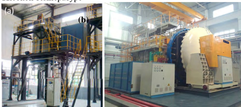
Рис. 1. (а) Крупногабаритная печь графитизации индукционного нагрева при умеренной частоте и (б) крупногабаритная печь графитизации с резистивным нагревом.
