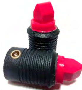
Рис. 4. Общий вид преобразователей для УЗК криволинейных зон.
