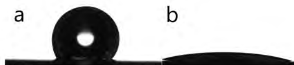
Рисунок 1. Микрофотографии капли олигосилоксана ОЭС-М на поверхности углеродного материала; а) капля ОЭС- Zr; б)- капля ОЭС- (Zr,Y).
