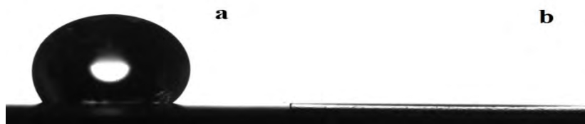
Рисунок 2. Микрофотографии капли олигосилазана ОЭС -М на поверхности углеродного материала: а) -ОМГС-Zr; б)- ОМГС- (Ta,Hf).
