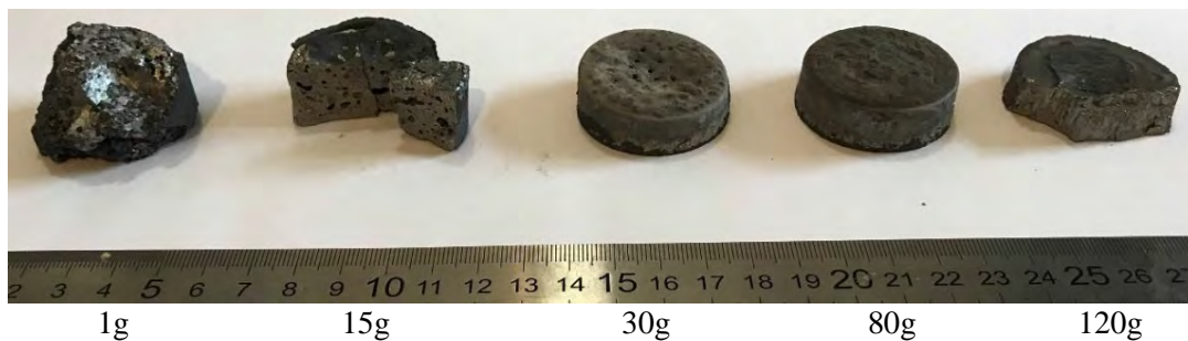
Рисунок 1 – Внешний вид слитков сплава CompoNiAl+La, полученных при различной перегрузке (g).
