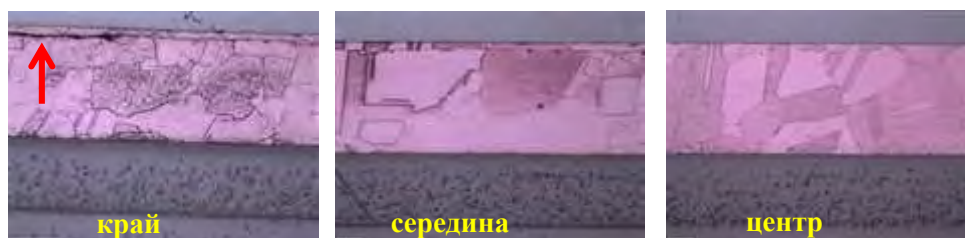
Рисунок 2 – Микроструктура медной прослойки ЗБП в зоне соединения после трех термоциклов
