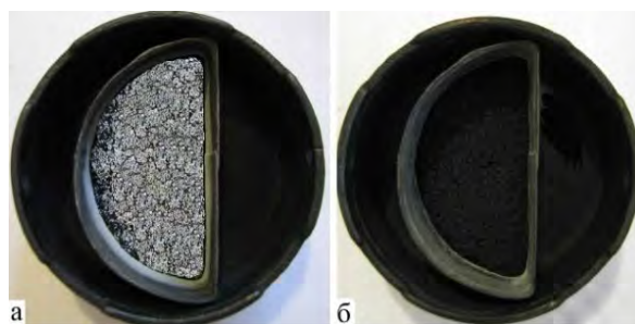
Прекурсоры: а – Cr_2O_3 , б – MgCr_2O_4 . T=750 °С, P=10 кПа Рисунок 1 – Вид тиглей с реакционной массой после восстановления
