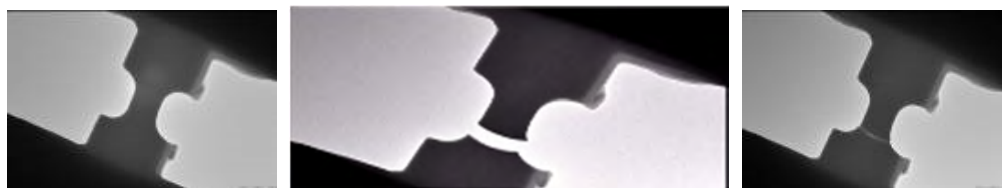
Рис. 1 – Стадии испытания на растяжение в модуле РТР покрытия Mo-Zr-Si-B
