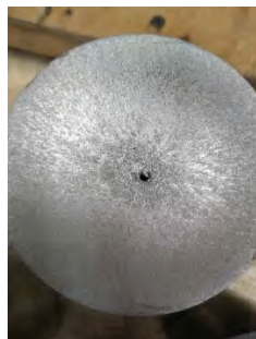
Рисунок 1 – Внешний вид усадочной раковины на торце оплаваемого электрода, полученного вакуумной индукционной плавкой
