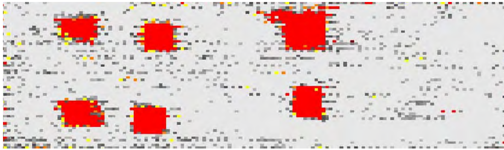
Рис. 3. С-скан образца с искусственными имитаторами дефектов и повышенным содержанием пор.
