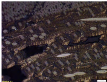
Рисунок 1 – Структура ПУ в УУКМ на основе каркаса нового поколения
