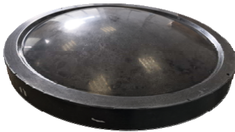
Рис. 2. Изготовленная оснастка для формования мембраны рефлектора
