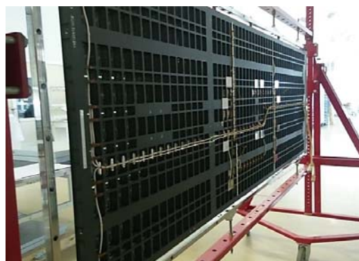
Рис. 2. Панели БС интегральной конструкции КА «АИСТ-2Д»
