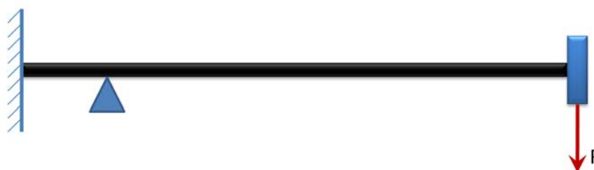
Схема нагружения мачты рефлектора при испытании на локальный прогиб
