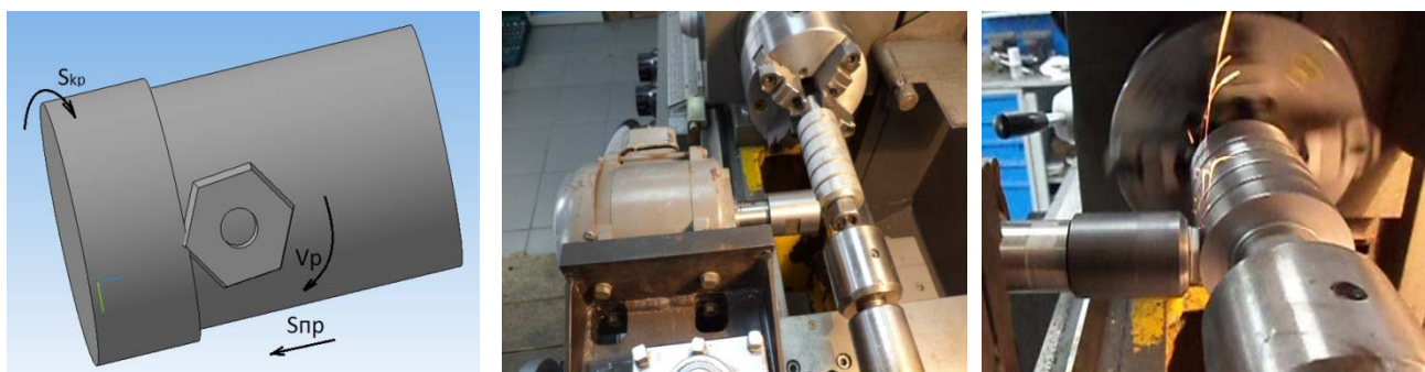
Рис. 1. Схема обработки многогранным ротационным резцом
