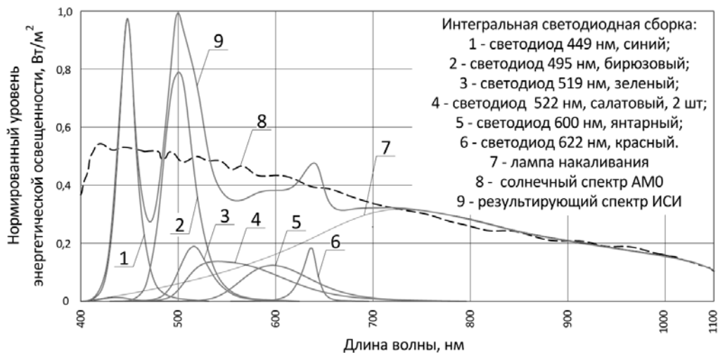
Спектр комбинированного ИСИ на основе интегральных светодиодных сборок и ламп накаливания
