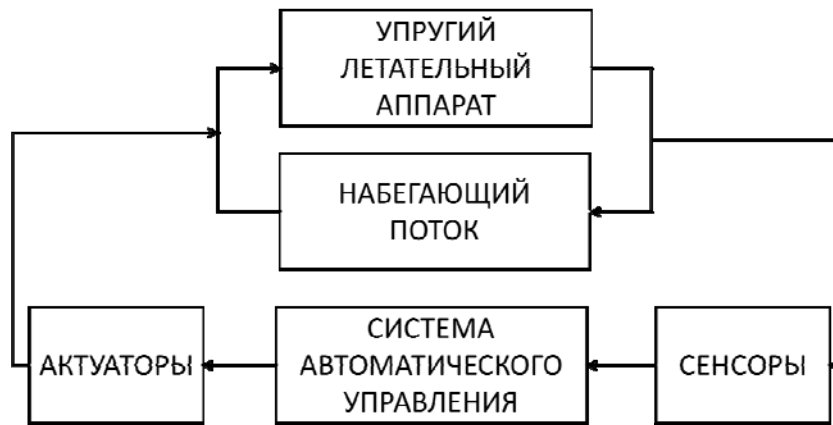
Системная модель аэросервоупругого летательного аппарата
