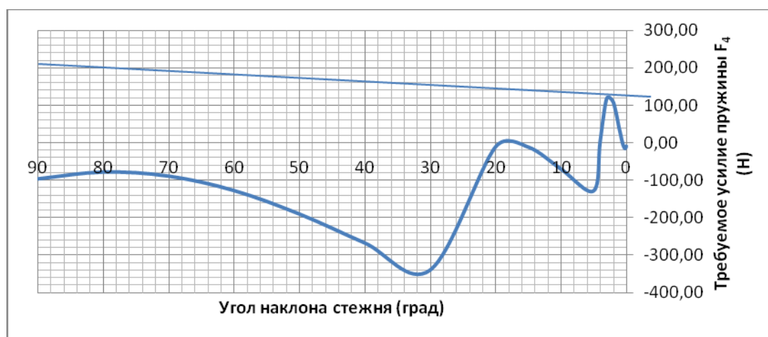
Рис. 4. Требуемое усилие и характеристика пружины сжатия
