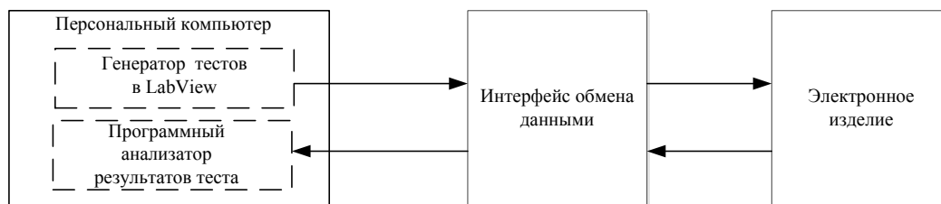
Структурная схема функционального тестирования
