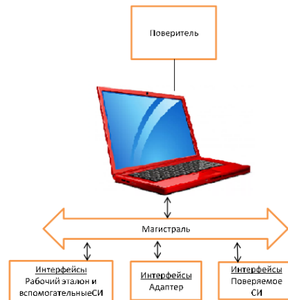
Рис. 3. Структура АРМ поверителя третьего уровня
