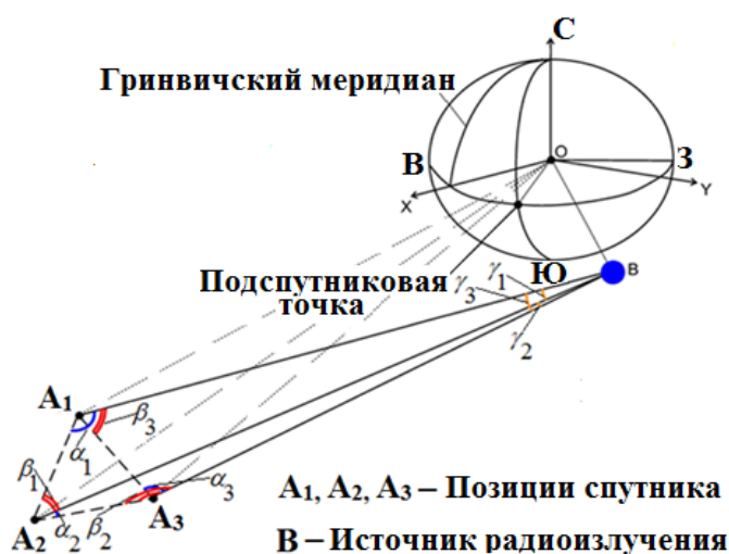
Рис. 3. Геометрические построения для метода определения координат ИРИ, основанном на использовании пирамиды
