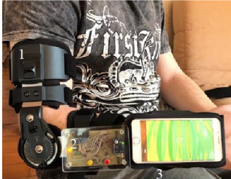
Рис. 1. Устройство для измерения угла наклона предплечья: 1 – ортез; 2 – инерциальный модуль; 3 – телефон
