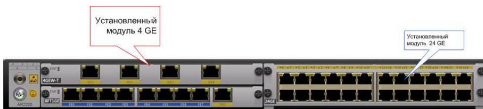
Рис. 4. Маршрутизатор после установки дополнительных модулей
