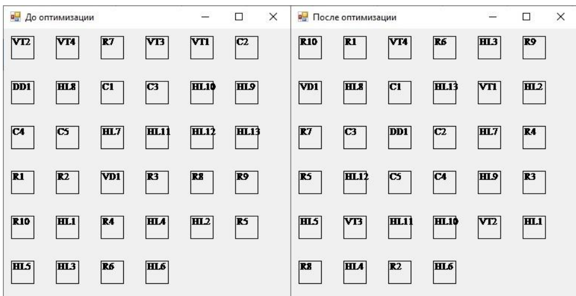
Рис. 2. Окно матрицы позиций расположения элементов до и после оптимизации
