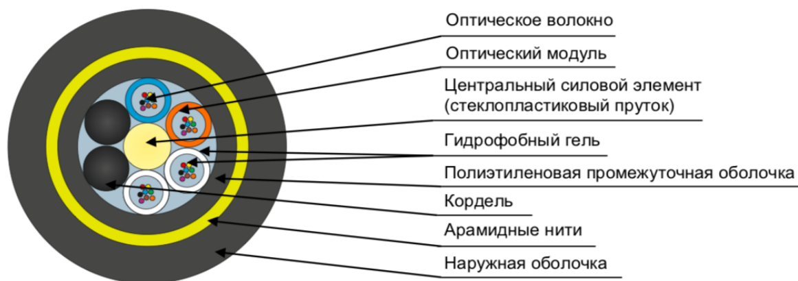
Рис. 1. Поперечное сечение ОКСН
