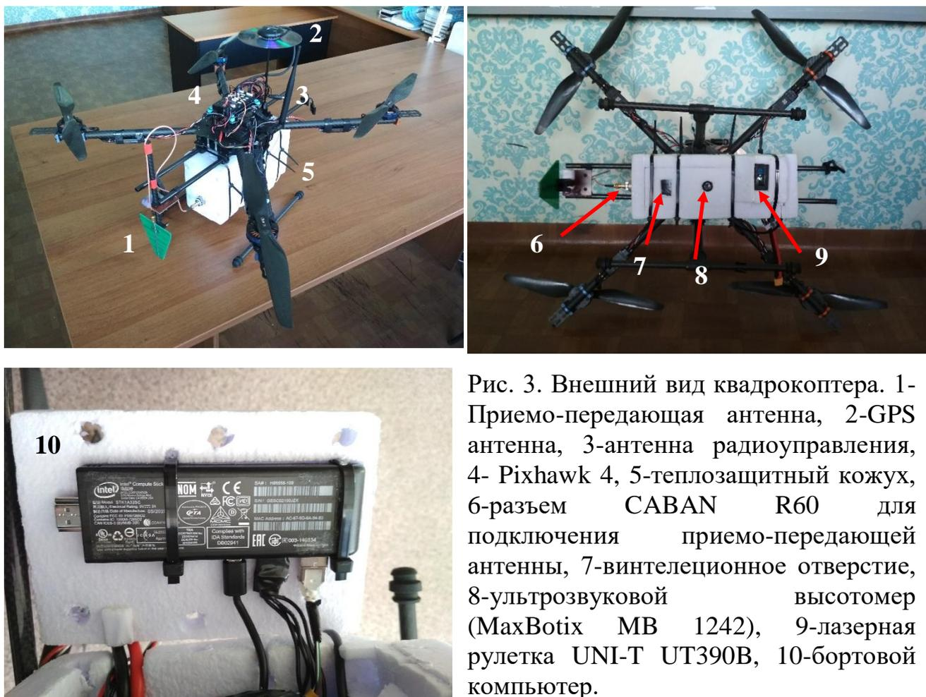
Рис. 3. Внешний вид квадрокоптера. 1- Приемо-передающая антенна, 2-GPS антенна, 3-антенна радиуправления, 4- Pixhawk 4, 5-теплозащитный кожух, 6-разъем SAVAN R60 для подключения приемо-передающей антенны, 7-винтелеционное отверстие, 8-ультразвуковой высотомер (MaxBotix MB 1242), 9-лазерная рулетка UNI-T UT390B, 10-бортовой компьютер.
