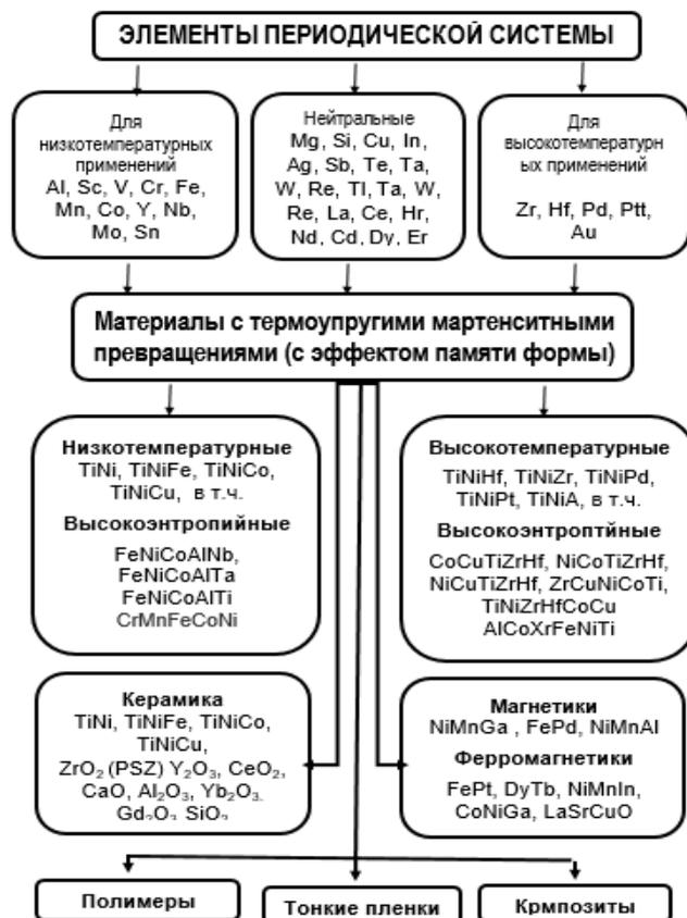
Рисунок 1 - Классификация элементов периодической системы и сплавов с ЭПФ по функциональному назначению для
