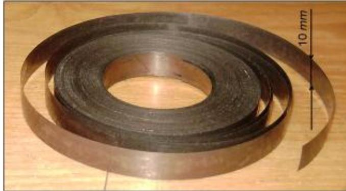
Рисунок 4 - Отрезок многослойной ленты  $Cu/Nb/D16$  длиной ~70 мм, шириной 10 мм и толщиной 60 мкм в медной оболочке
