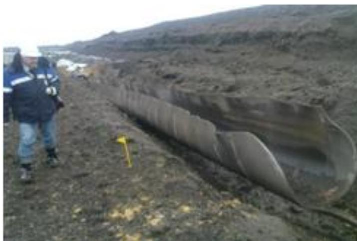
Рисунок 2 – Вязкое разрушение магистрального трубопровода
