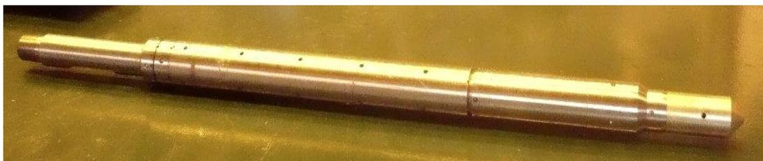
Рисунок 3 - Ультразвуковой скважинный прибор ПСМС–102
