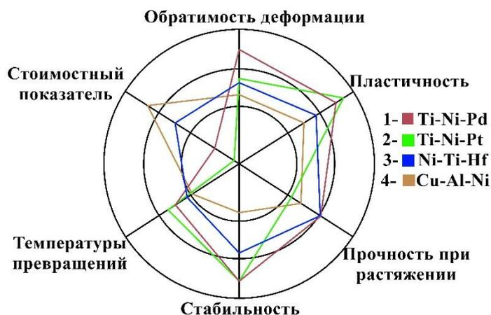
Рисунок 4 - Круговая диаграмма основных функциональных характеристик и стоимости сплавов с ЭПФ для высокотемпературных применений
