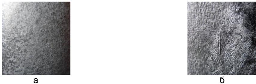
Рисунок 2 - Макроструктура поверхности кокильного литья из сплава АК9.
