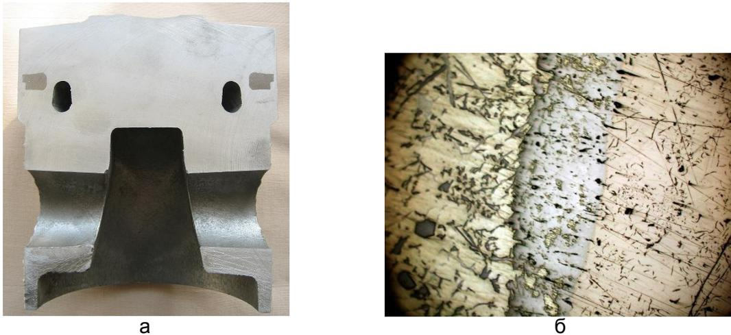
Рисунок 7 - Поршень с нирезистовой вставкой и полостью масляного охлаждения.
