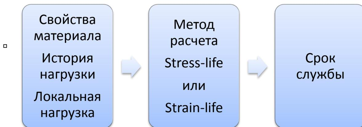
Рисунок 7 - Расчет усталости детали
