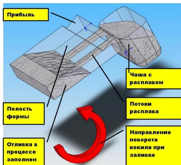
Рисунок 3 - Схема метода самозаполнения при верхней заливке расплава в кокиль.
