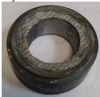
Рисунок 1 - Внешний вид заготовки после наплавки покрытия из алюминий-кремниевое сплава с подслоем из свинцового сплава
