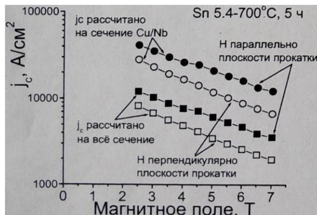
Рисунок 18 - Критическая плотность тока Nb<sub>3</sub>Sn-ленты, полученной из ленты Cu12Sn/(Nb/Cu) с двумя многослойными Nb/Cu-слоями
