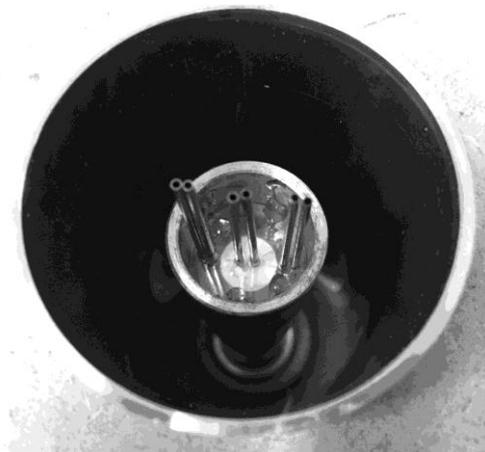
Рисунок 6 - Сборка со световодами, смонтированная в цилиндрическом лайнере генератора
