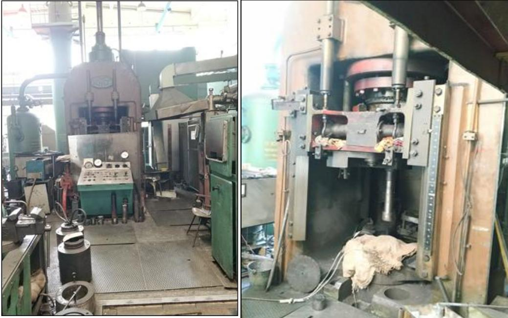
Рисунок 2 - Общий вид вертикального прессы усилием 630 Т (слева) и его рабочего пространства перед прессованием (справа). Контейнер накрыт асбестовым полотном для сохранения им требуемой температуры перед прессованием. На переднем плане левого рисунка видны два контейнера с различными внутренними диаметрами
