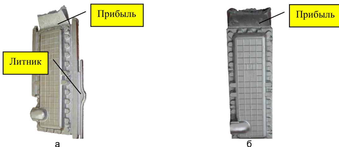
Рисунок 4 - Отливки детали 540-1714056 «Бачок масляного радиатора», полученные различными методами литья
