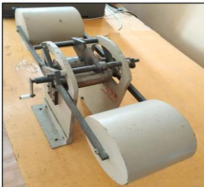
Рисунок 1 - Устройство-станок для намотки Nb-и Д16-фольг наNb-стержень
