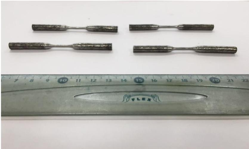
Рисунок 5 - Исходный вид образцов для испытаний на растяжение
