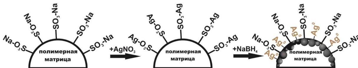
Рис. 1. Образование коллоидных частиц серебра в структуре ионообменной матрицы КУ-2-8 [3]
