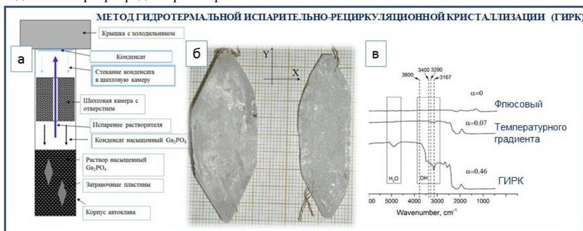
Рис. 1. а-принципиальная схема процесса выращивания кристаллов \text{GaPO}_4 методом ГИРК в водных растворах кислот \text{H}_3\text{PO}_4+\text{HCl} ; б-монокристаллы \text{GaPO}_4 , в-ИК-спектры кристаллов \text{GaPO}_4 , полученных методами: ГИРК, температурного перепада и флюсовым.
