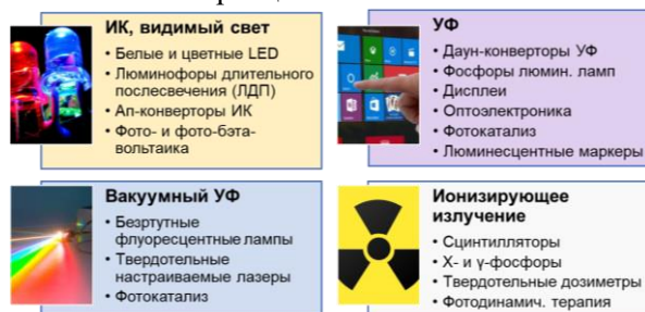
Рис. 1 Группы люминесцентных и оптических материалов на базе РЗ элементов в зависимости от вида и энергии фотонного возбуждения
