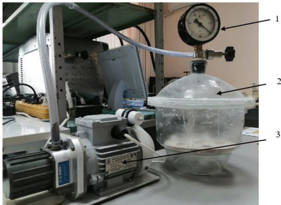
Рисунок 2.1 – Вид вакуумной установки для насыщения образцов. 1 – манометр; 2 – эксикатор; 3 – вакуумный насос.
