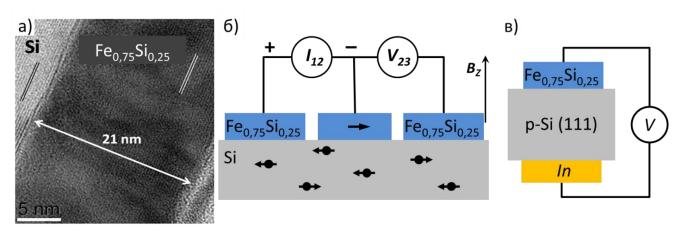
Рисунок 4.4 – (а) ПЭМ-изображение высокого разрешения сечения структуры  $Fe_{0,75}Si_{0,25}$  / p-Si (111). Экспериментальные схемы и эскизы показаны для (б) 3-контактного планарного микроустройства для изучения эффекта Ханле и (в) диода Шоттки для определения электрических характеристик
