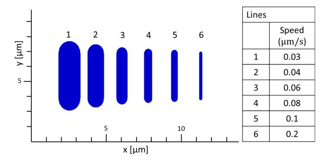
Рисунок 3.3 – Фрагмент окна программы InkCAD с изображением шаблона калибровки. Представлены линии (слева) и соответствующие им скорости перемещения зонда (справа)
