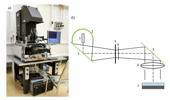
Рисунок 2.8 - Установка совмещения и экспонирования EVG 610. Общий вид установки (а); оптическая схема установки оптической литографии (б): 1 — отражатель, 2 — ртутная лампа, 3 —зеркало, 4 — заслонка, 5 — блок растров, 6 — конденсорная линза, 7 — шаблон, подложка
