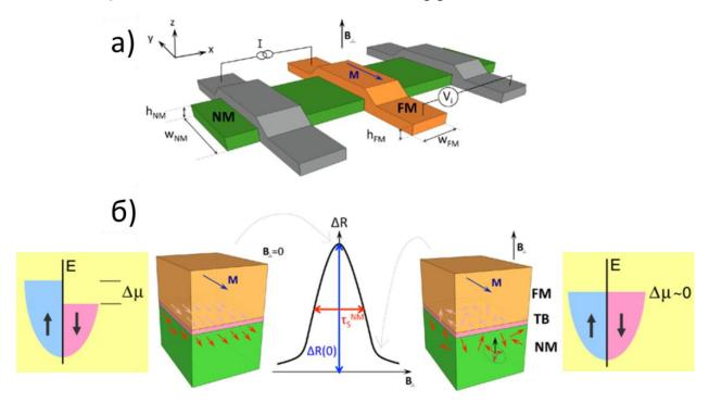
Рисунок 1.10 - Схематическое изображение эффекта Ханле. (а) Схема 3-х контактного устройства для измерения эффекта Ханле. Электроды серого цвета могут быть либо ФМ, либо НМ. (б) Показана электрическая конфигурация и ФМ-электрода намагниченность направлении при магнитного поля  $(B_{\perp})$ . перпендикулярно плоскости В квадратных вставках приведено схематическое объяснение эффекта Ханле при различных значениях В<sub>1</sub> [73]
