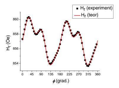
Рисунок 2.15 - Экспериментальная (точки) и рассчитанная (сплошная линия) азимутальные зависимости резонансного поля для пленки  $Fe_{0,75}Si_{0,25}$
