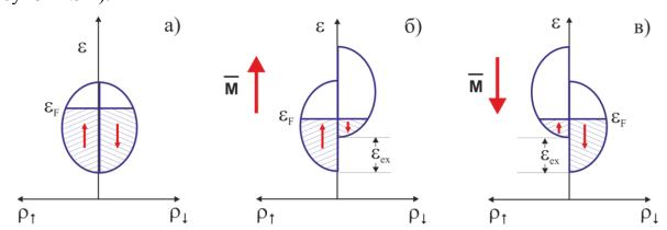
Рисунок 1.5 Зонная структура немагнитного и ферромагнитного металлов. Для немагнитного металла подзоны для электронов со спинами «вверх» и «вниз» симметричны (а); для ФМ подзоны сдвинуты относительно друг друга на величину обменного взаимодействия (б); изменение направления намагниченности влечет изменение расщепления плотности состояний на противоположное (в)
