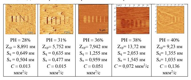
При параметрах процесса  $PT = 27 \pm 0.1$  °C и  $PH = 38 \pm 0.5\%$  скорость диффузии молекул достаточна для формирования линий различной ширины и не приводит излишнему «растеканию» слоя молекул и образованию подтёков. Проведение процесса литографии в условиях повышенной влажности позволяет наносить маски как в виде одиночных тонких линий, так и равномерно закрашенных фигур большой площади.
