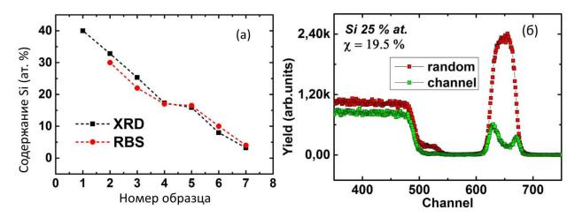
Рисунок 2.13 - Содержание Si (ат. %), полученное из измерений РСА и РОР (а). Спектры РОР для  $Fe_{0,75}Si_{0,25}$  / Si (111), выращенного при 400 K (б)
