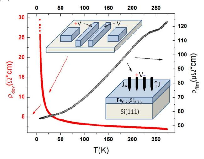
Рисунок 4.3 - Температурные зависимости сопротивления пленки  $Fe_{0,75}Si_{0,25}$  (правая ось) и планарного устройства  $Fe_{0,75}Si_{0,25}$  / Si (111) (левая ось). На вставках показана экспериментальная геометрия для обоих образцов
