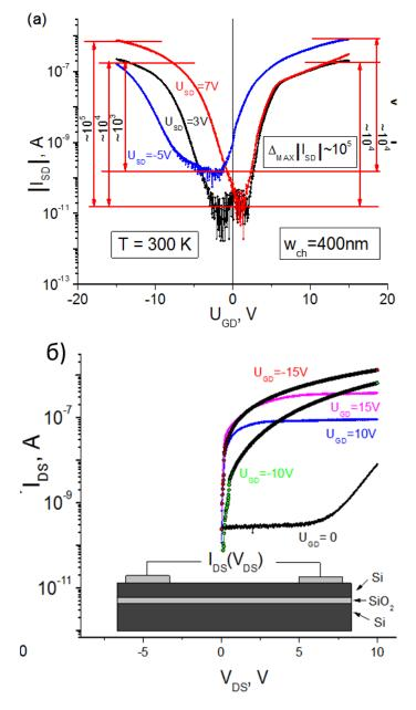
Рисунок 3.15 - Зависимость тока сток—исток (а) при 300 К и ширине транспортного канала 400 нм от напряжения на нижнем затворе при различных смещениях на стоке: –5 В (синий); 3 В (черный); 7 В (красный). Вольт-амперные характеристики сток-исток (б) при различных смещениях на затворе: 0 В (чёрный); –15 В (красный); –10 В (зелёный); 10 В (синий); 15 В (розовый)
