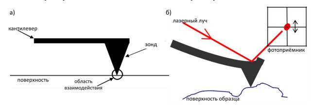
Рисунок 2.7 - Общая схема конструкции зонд-кантилевер (а). Оптическая схема регистрации силового АСМ взаимодействия, включающая источник (лазер) и приёмник (4-х секционный фотодетектор) (б)
