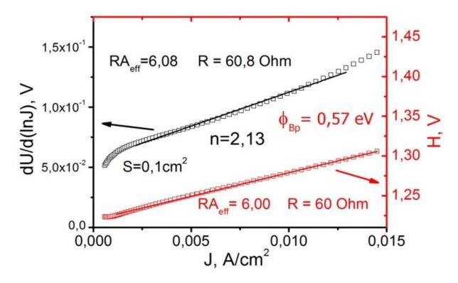
Рисунок 4.7 – графики зависимости dU/d(lnJ) от функции H (девая) и от J (правая) диода Шоттки  $\mathrm{Fe}_{0.75}\mathrm{Si}_{0.25}$  / p -  $\mathrm{Si}$ .
