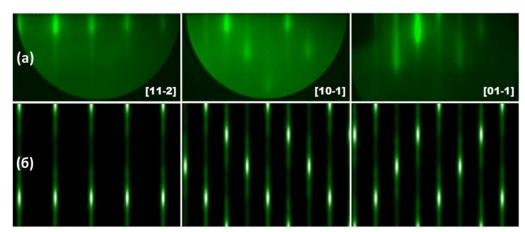
Рисунок 2.11 - Экспериментальная картина ДБОЭ *in situ* вдоль [11-2], [10-1] и [01-1] направлений поверхности структуры  $Fe_{0,75}Si_{0,25}/Si(111)$  после роста (а); моделирование ДБОЭ -картин поверхности  $Fe_{0,75}Si_{0,25}$  при одинаковых направлениях луча (б)
