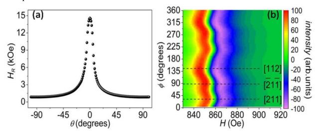
Рисунок 2.14 - Полярные угловые зависимости резонансного поля  $H_R$  (геометрия out-of-plane) (а). Карта амплитуды спектров ФМР азимутальной угловой зависимости (геометрия in-plane) (б). Пунктирными линиями показаны кристаллографические направления [112], [21-1] и [211]
