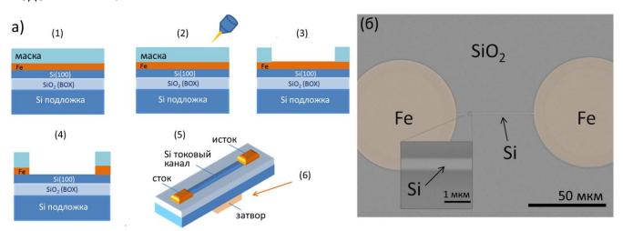
Рисунок 3.12 - Схема изготовления нанопроволочного устройства (а). Слева на право перечислены основные этапы: нанесение резиста (1), экспонирование электронным лучом согласно шаблону (2), проявление резиста (3), жидкое химическое травление слоя Fe в растворе соляной кислоты (4), реактивное ионное
