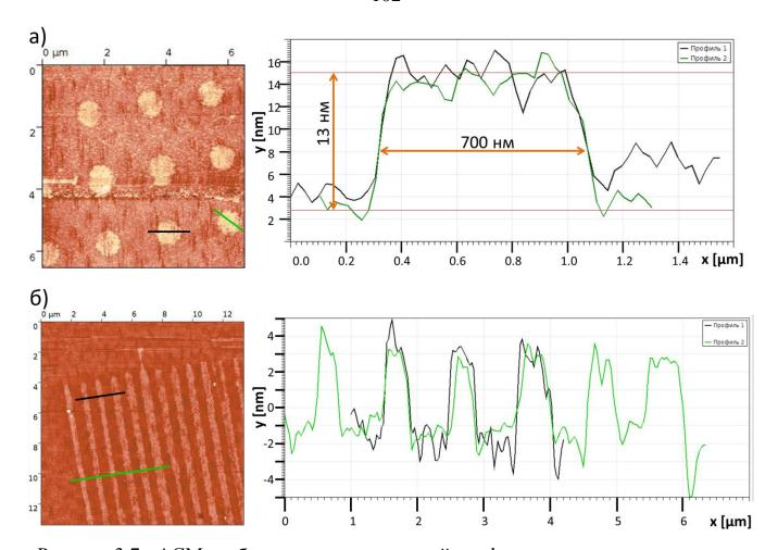
Рисунок 3.7 - АСМ изображения и одномерный профиль сечения для структур с различной геометрией после процесса литографии и этапа травления золота. Область 7×7 мкм массива круглых структур диаметром 700 нм (а); область 13×13 мкм массива полос различной ширины (б)
