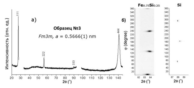
Рисунок 2.12 - Наблюдаемые рентгенограммы для четырех характерных дифракционных пиков  $Fe_{0,75}Si_{0,25}$  (a). 2D-изображения для  $\phi$ -сканов отражений  $\{224\}$  от пленки  $Fe_{0,75}Si_{0,25}$  и Si подложки (б)
