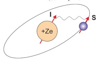
Рисунок 1.3 - Схема возникновения сверхтонкого взаимодействия
