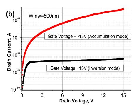
Рисунок 3.17 — Сток-затворные характеристики Co<sub>2</sub>FeSi/KHИ нанопроволочных транзисторов с нижним затвором, для различной ширины токового канала от 250 нм до 1000 нм (а). Графики построены в полулогарифмическом масштабе при разных напряжениях на стоке-истоке. (б) Выходные характеристики устройства с шириной канала 500 нм, в режиме инверсии и аккумуляции
