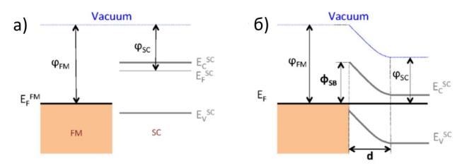
Рисунок 1.8 - Энергетическая зонная диаграмма барьера Шоттки. Диаграммы энергетических зон ФМ и ПП до (a) и после (б) приведения их в контакт [50]
