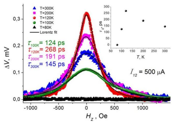
Рисунок 4.5 - Кривые Ханле для устройства  $Fe_{0,75}Si_{0,25}$  / p-Si при  $I_{12} = +500$  мкА и температурах 300 K, 200 K и 120 K (символы) и аппроксимация Лоренца (сплошные линии). На вставке представлена зависимость времени жизни спинового состояния от температуры
