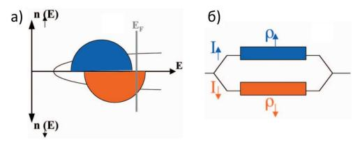
Рисунок 1.4 - Модель двух токов. Схема зонной структуры ФМ, показывающая спиновое расщепление энергетических зон (а); схема спин-зависимой проводимости через независимые спиновые каналы со спином ↓ и спином ↑ в пределе пренебрежимо малого спинового перемешивания (б) [15]
