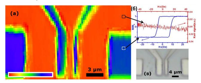
Рисунок 4.2 - Поверхностное распределение угла поворота Керра в магнитном поле 250  $\Im$  (a),  $Fe_{0,75}Si_{0,25}$  МОКЕ петля гистерезиса (б). Оптическое изображение  $Fe_{0,75}Si_{0,25}$  / Si (111) 4-контактного планарного устройства (в)
