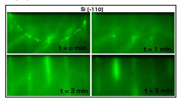
Рисунок 2.10 - Эволюция экспериментальной картины ДБОЭ вдоль направления Si [-110] поверхности Si (111) в процессе роста эпитаксиальной пленки  $Fe_{0,75}Si_{0,25}$
