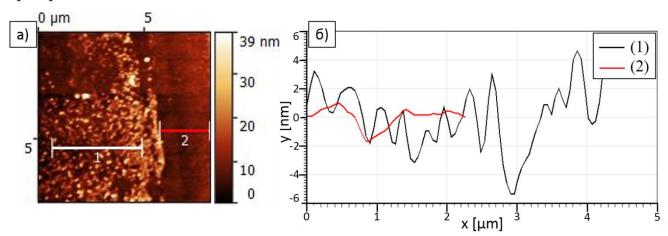
Рисунок 2.19 - АСМ изображение ступеньки плёнки после процесса травления. Топографическое АСМ изображение границы травления (а). Одномерный график извлечённых профилей (б): (1) — область плёнки, защищённая резистивной маской; (2) — область после травления
