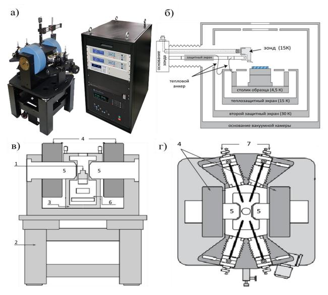
Рисунок 2.5 - Криогенная зондовая станция Lakeshore EMPX-HF 2. Общий вид установки (а); схема измерительной камеры (б); схема станции, вид спереди (в); схема станции, вид сверху (г). Цифрами обозначены основные составные части установки: 1 – предметный столик, 2 – виброизолирующий стол, 3 – вакуумная камера, 4 – катушки электромагнита, 5 – полюса электромагнита, 6 – криостат, 7 – блоки (руки) с микроманипуляторами и зондовыми датчиками (4 шт.)
