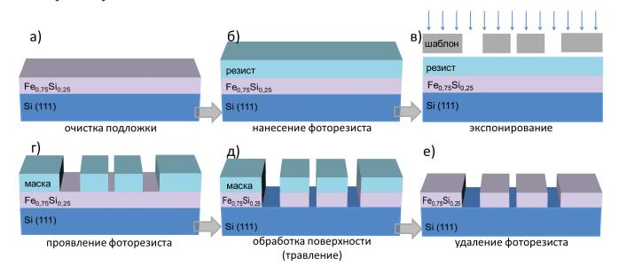
Рисунок 2.20 - Основные технологические операции изготовления 4-х контактной структуры методом оптической литографии и жидкого химического травления
