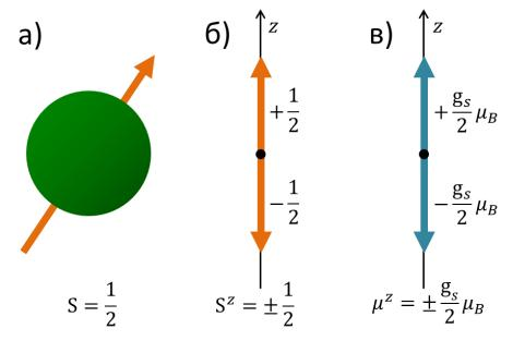
Рисунок 1.1 - Электрон: спин электрона (а); собственные значения проекции спинового момента количества движения (б) и магнитного момента электрона (в) на ось квантования z
