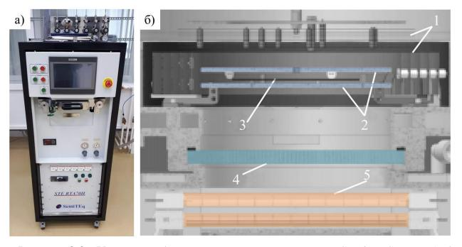
Рисунок 2.3 - Установка быстрого термического отжига Semiteq STE RTA70H. Общий вид установки (а); схема камеры отжига (б): 1 – тепловые экраны; 2 – термостатирующие элементы; 3 – образец; 4 – кварцевое окно для ввода излучения; 5 – массив галогеновых ламп
