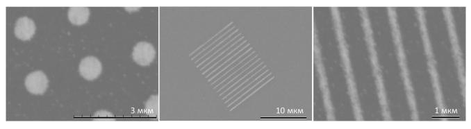
Рисунок 3.8 - СЭМ изображения структур в виде линий и кругов из Au/  $Fe_{0.75}Si_{0.25}$  на Si (111)
