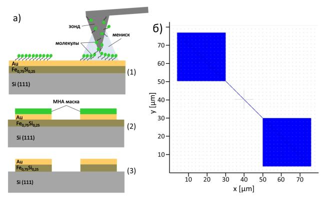
Рисунок 3.9 - Схема создания структур при помощи процесса перьевой нанолитографии (а): нанесение молекул МНА при помощи зонда (1); травление слоя золота (2); травление слоя силицида с участков, не защищённых золотом (3). Схема шаблона структуры в окне программы InkCAD (б)
