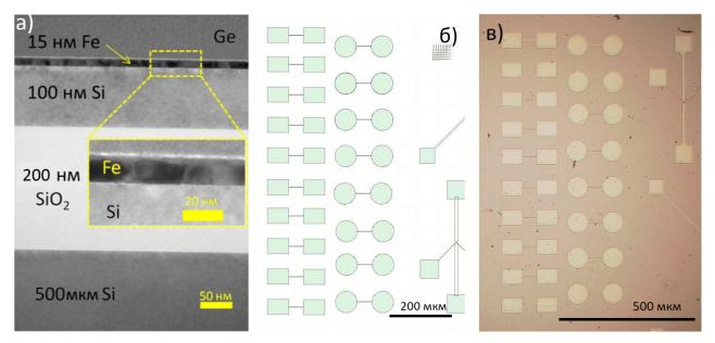
Рисунок 3.11 - ПЭМ-изображение поперечного среза структуры Fe/КНИ с обозначением материала слоев и толщин (а); участок шаблона, спроектированный в программе LayoutEditor (б); оптическое изображение устройств (в)
