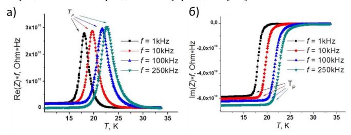
Рисунок 4.8 – Температурные зависимости нормированных активного (a) и реактивного (б) сопротивлений на разных частотах
