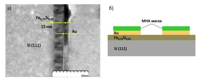
Рисунок 3.6 - ПЭМ изображение Au ступеньки (структуры Au/  $Fe_{0,75}Si_{0,25}/Si(111)$ ) после процесса травления (а); схематическое изображение структуры после частичного удаления слоя Au (б)
