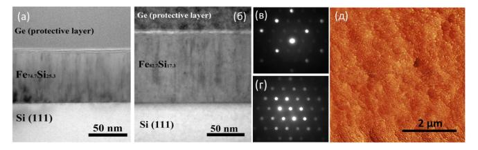
Рисунок 2.17 - Структурные свойства  $Fe_{1-x}Si_x$ , выращенного на Si (111). Поперечные сечения ПЭМ (а, б) изображений двух составов  $Fe_{1-x}Si_x$ . Картина дифракции электронов плёнки  $Fe_{0,8}Si_{0,02}$  (в) и Si (г). Ось зоны параллельна направлению [110]. Типичное АСМ-изображение поверхности плёнки (д)
