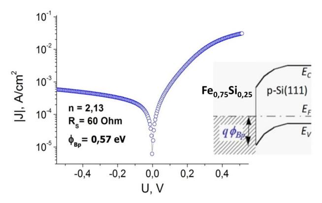
Рисунок 4.6 — Вольт-амперная характеристика диода Шоттки  $Fe_{0,75}Si_{0,25}$  / p-Si при 295 К. На вставке схематично показана энергетическая диаграмма барьера Шоттки для  $Fe_{0,75}Si_{0,25}$  / p- Si (111)
