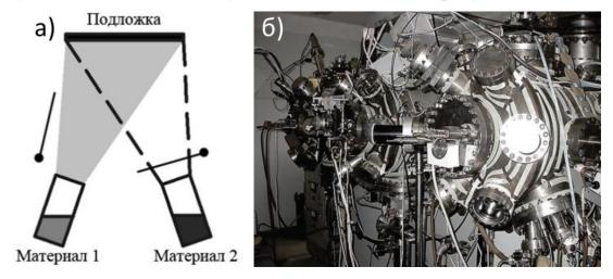
Рисунок 2.1 - Принципиальная схема метода МЛЭ (a) и фотографическое изображение модульной установки МЛЭ «Ангара» (б)
