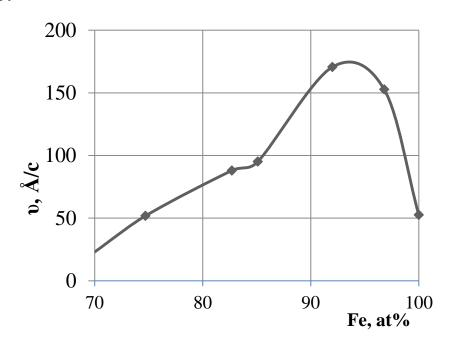
Рисунок 2.18 - Зависимость скорости травления сплава  $Fe_{1-x}Si_x$  с различным содержанием кремния и железа, при температуре  $22^{\circ}$  С
