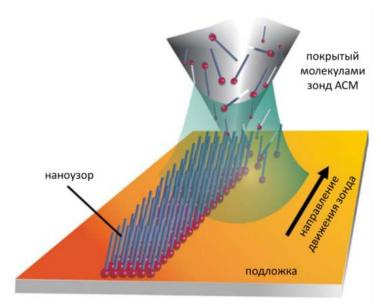
Рисунок 3.1 - Схема процесса перьевой нанолитографии. Покрытый молекулами зонд ACM наносит молекулы на подложку через водный мениск
