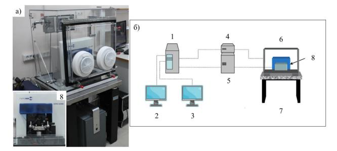
Рисунок 2.6 - Установка атомно-силовой микроскопии NanoInk DPN 5000. Общий вид установки (а). На вставке (8) представлено изображение модуля АСМ микроскопа-литографа. Схема АСМ включает в себя (б): 1 — управляющий компьютер; 2 — главный монитор; 3 — видео-монитор; 4 — контроллер камеры искусственного климата; 5 — контроллер литографии; 6 — камера искусственного климата; 7 — антивибрационный стол (на воздушной подушке); 8 — модуль DPN
