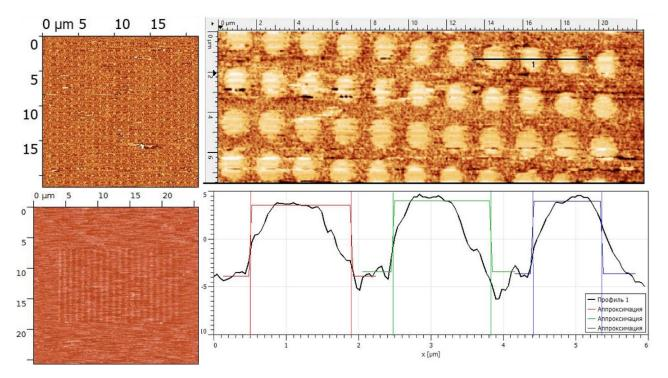
Рисунок 3.5 - ЛСМ изображение структур в виде линий и точек из МНА на поверхности  $Au/Fe_{0,75}Si_{0,25}/Si(111)$ . Профиль сечения демонстрирует диаметр круглых элементов  $\sim 1,3$  мкм
