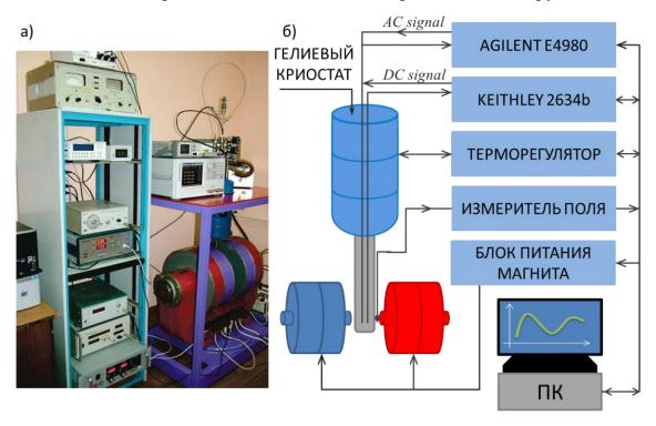
Рисунок 2.4 - Установка для прецизионных исследований транспортных и магнитотранспортных свойств структур на переменном токе. Общий вид установки (а); блок-схема (б)
