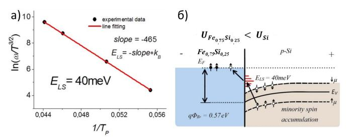
Рисунок 4.9 - График зависимости  $ln(\omega/T_P^{3/2})$  от  $1/T_P$  (а). Схематическая зонная диаграмма (б), изображающая перенос спин-поляризованных дырок через переход  ${\rm Fe_{0,75}Si_{0,25}}/p{\rm -Si}$  через локализованные интерфейсные состояния при помощи туннелирования
