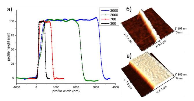
Рисунок 3.13 - АСМ топологии поверхности Si токовых каналов структур. Одномерные профили сечения для каналов различной ширины (а). 3-d изображения Si каналов: шириной 300 нм (б) и 3000 нм (в)
