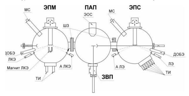
Рисунок 2.2 - Схема установки МЛЭ «Ангара». ЭПМ – модуль эпитаксии элементарных полупроводников, металлов и диэлектриков; ЭПС – модуль эпитаксии полупроводниковых соединений; ПАП – модуль анализа и подготовки подложек; ЗВП – модуль загрузки и выгрузки подложек; ТИ – тигельные испарители; ЛКЭ – лазерный керрэллипсометр (А – анализатор); ЛЭ – лазерный эллипсометр (А – анализатор); ДОБЭ – дифрактометр отраженных быстрых электронов; МС – масс-спектрометр; ШЗ – шиберный затвор
