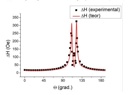
Рисунок 2.16 - Экспериментальная (точки) и рассчитанная (сплошная линия) полярные зависимости ширины линии ФМР для пленки Fe<sub>0,75</sub>Si<sub>0,25</sub> Общая ширина линии определяется выражением:
