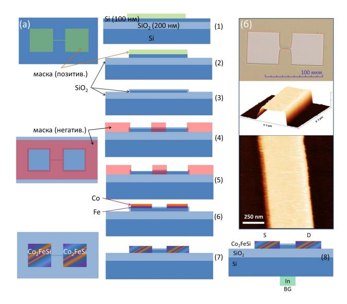
Рисунок 3.14 - Основные технологические этапы изготовления НП полевых транзисторов (а). Сверху вниз перечислены основные этапы: электронная литография (1), травление Si (2), окисление тонкого слоя Si (3), оптическая литография (4), травление SiO<sub>2</sub> в области контактных площадок (5), осаждение Со и Fe с последующей очисткой подложки (6), быстрый термический отжиг (7), готовое устройство с нижним затвором (8). Изображения устройства шириной 500 нм (б)
