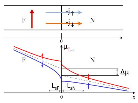
Рисунок 1.7 - Схема пространственного распределения химического потенциала вблизи контакта ФМ/НМ
