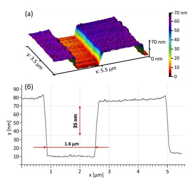
Рисунок 4.1 - АСМ-изображение (а) и одномерный профиль (б) устройства  $Fe_{0.75}Si_{0.25}$  на подложке Si (111) после травления
