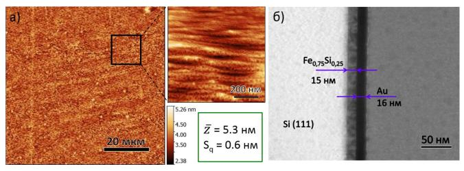
Рисунок 3.2 - АСМ изображение топологии поверхности Au/  $Fe_{0,75}Si_{0,25}/Si(111)$  структуры для области сканирования  $70\times70$  мкм (а). На вставке представлено изображение для области  $1\times1$  мкм. ПЭМ изображение поперечного среза гетероструктуры Au/  $Fe_{0,75}Si_{0,25}/Si(111)$  (б). Толщины слоёв Au и  $Fe_{0,75}Si_{0,25}$  составляют 15 и 16 нм соответственно
