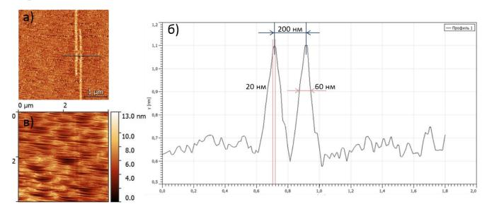
Рисунок 3.4 - Изображение полос МНА на поверхности Au/Fe<sub>0,75</sub>Si<sub>0,25</sub>/Si(111). ЛСМ изображение полос из МНА (а); одномерный профиль сечения демонстрирует ширину линий (расстояние между линиями  $\sim$  200 нм) (б); изображения топологии поверхности, полученное в контактном режиме сканирования (Z ср = 7,34 нм; Sq = 1,754 нм) (в). Представлена область сканирования 5×5 мкм
