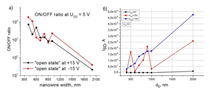
Рисунок 3.16 – Зависимость отношения токов "включенного" и "выключенного" транзистора от ширины канала при "включенном" напряжении: –15 (красный); +15 В (чёрный). Зависимость величины тока сток-исток от ширины токового канала (б)
