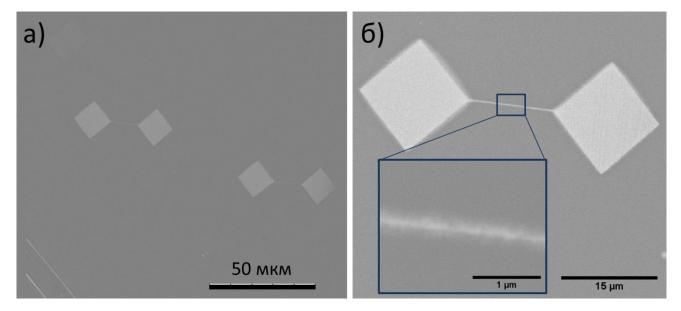
Рисунок 3.10 - СЭМ изображения структур с наноразмерным проволочным каналом из  $Au/Fe_{0,75}Si_{0,25}$  на подложке Si(111). Общий вид (a); увеличенное изображение НП канала (б)
