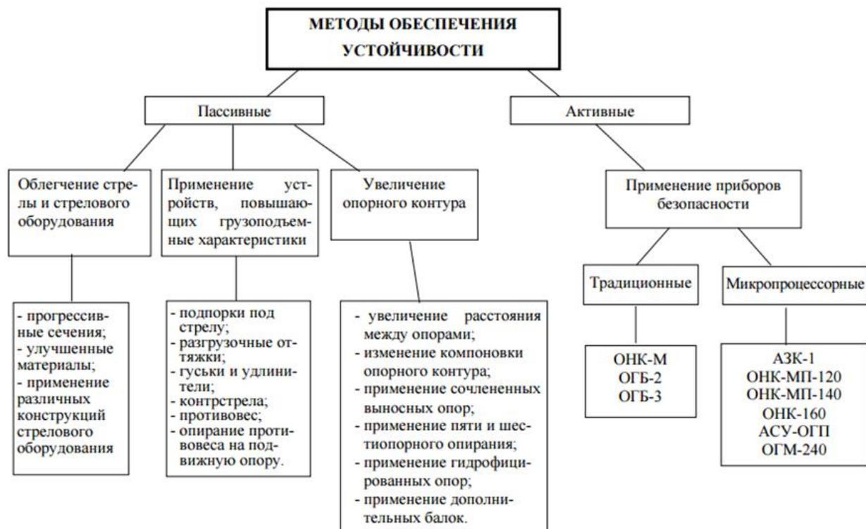
Рисунок 1. Методы обеспечения устойчивости грузоподъемных кранов
