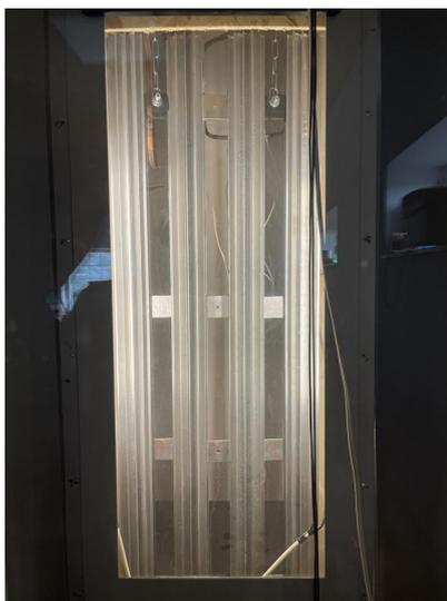
Рисунок 4. Теплообменник испарительного блока воздушного теплового насоса с антиобледенительной системой MOVEBIT
