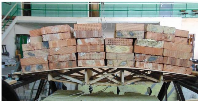
Рисунок 5. Нагружение уменьшенной модели ППП расчетной равномерно распределенной равносторонней нагрузкой ( $3,73 \text{ кН/м}^2$ )
