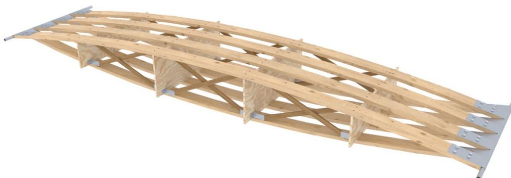
Рисунок 3. 3D-модель ППП из деревянных полосовых элементов
