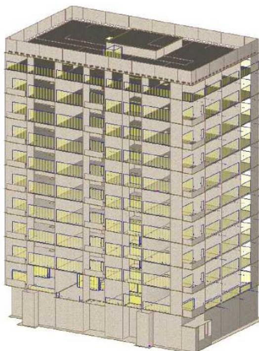
Рисунок 6. «Аналитическая модель» здания в САПФИР с нагрузками от архитектурных стен
