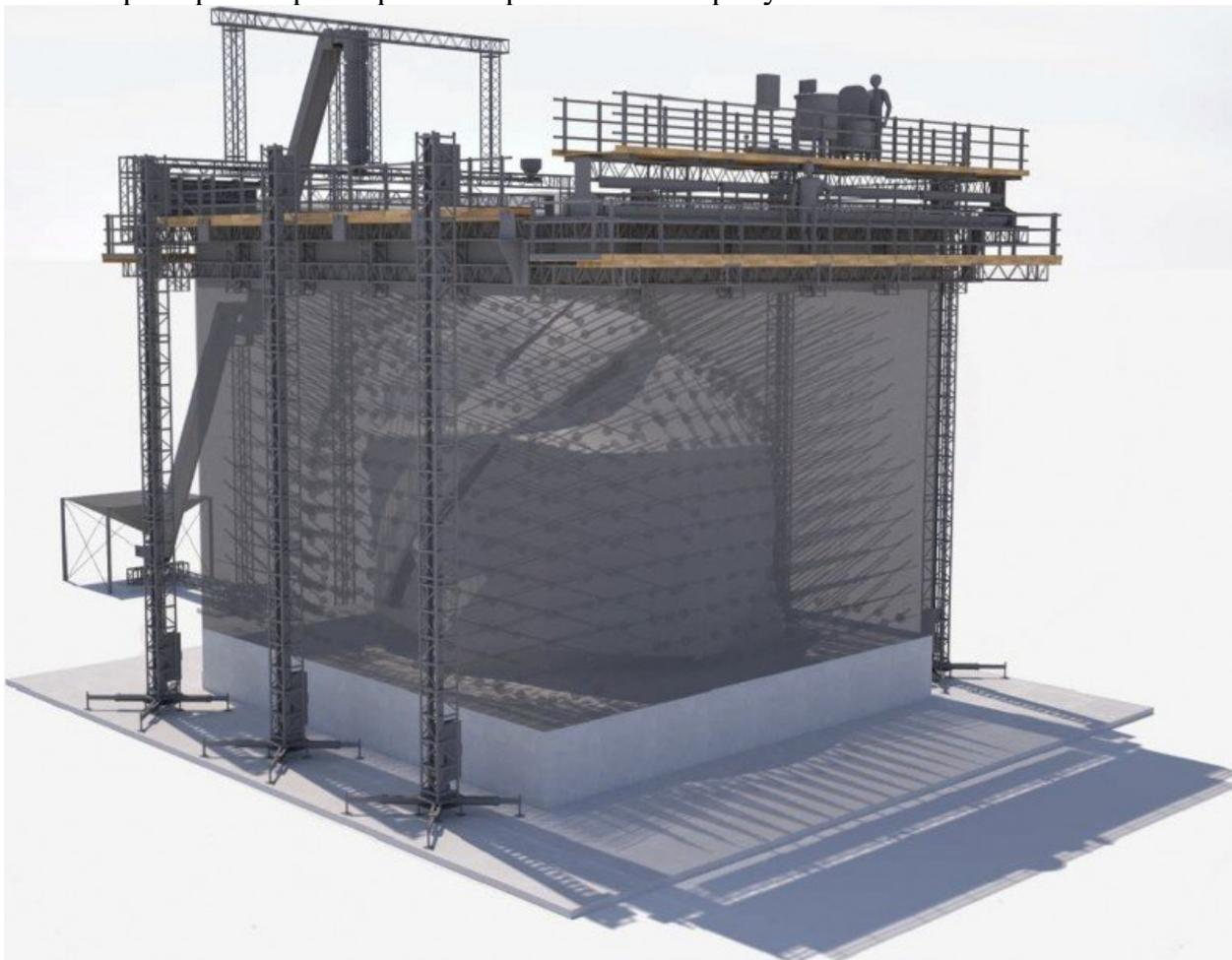
Рисунок 4. Строительный 3D-принтер D-Shape
