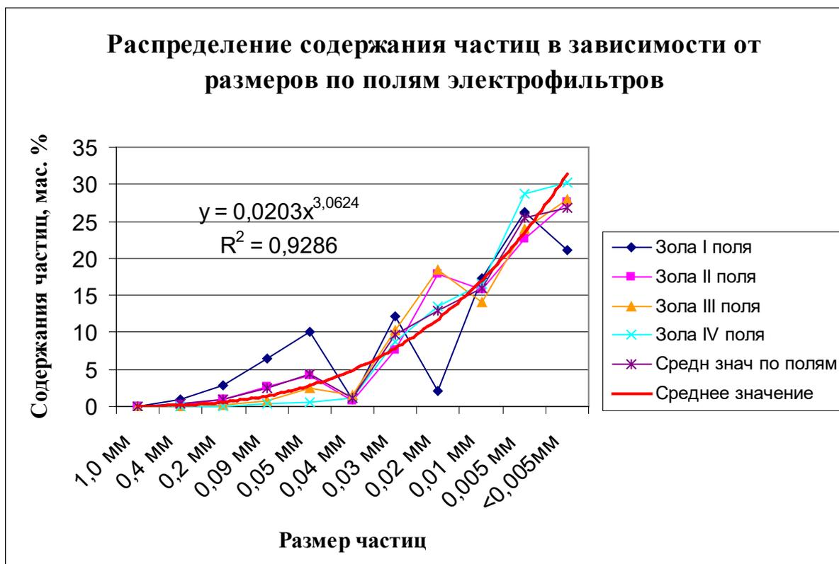
Рисунок 2. Распределение частиц золы-уноса в зависимости от их размеров по полям электрофильтров в массовых процентах
