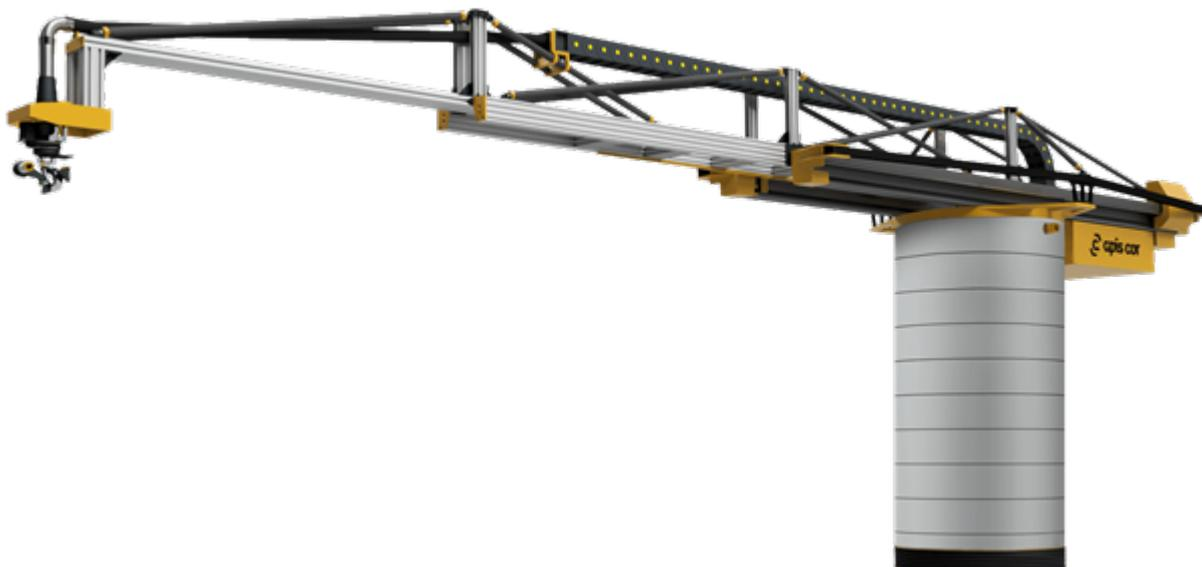
Рисунок 3. Строительный 3D-принтер Aris Cor
