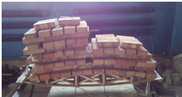
Рисунок 6. Нагружение уменьшенной модели ППП распределенной односторонней нагрузкой, равной  $1,5 q_{расч}$  ( $7,23 \text{ кН/м}^2 / 4,44 \text{ кН/м}^2$ )
