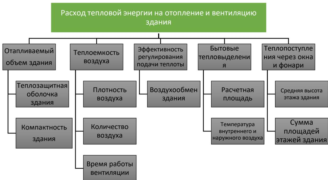
Рисунок 1. Факторы необходимые для расчета тепловой энергии на отопление и вентиляцию здания
