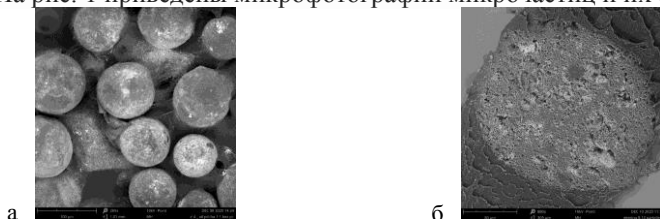
Рис. 1. Микрофотография полимерных микрочастиц (а) и их среза (б)
