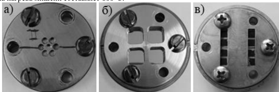
Рис. 1. Сборки с образцами: Ø3 мм (а), квадратные 10x10 мм (б), ВТСП лент (в)
