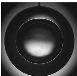
Рис. 1. Криогенный слой дейтерия в сферической оболочке, разнотолщинность \approx 1\% при средней толщине слоя 311 мкм.
