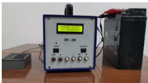
Рис. 1. Внешний вид радиометра а); исследования почвенного слоя (б): 1 — изменение влажности во времени 2 — изменение интенсивности объемной активности радона во времени, 3 — изменение температуры во времени.
