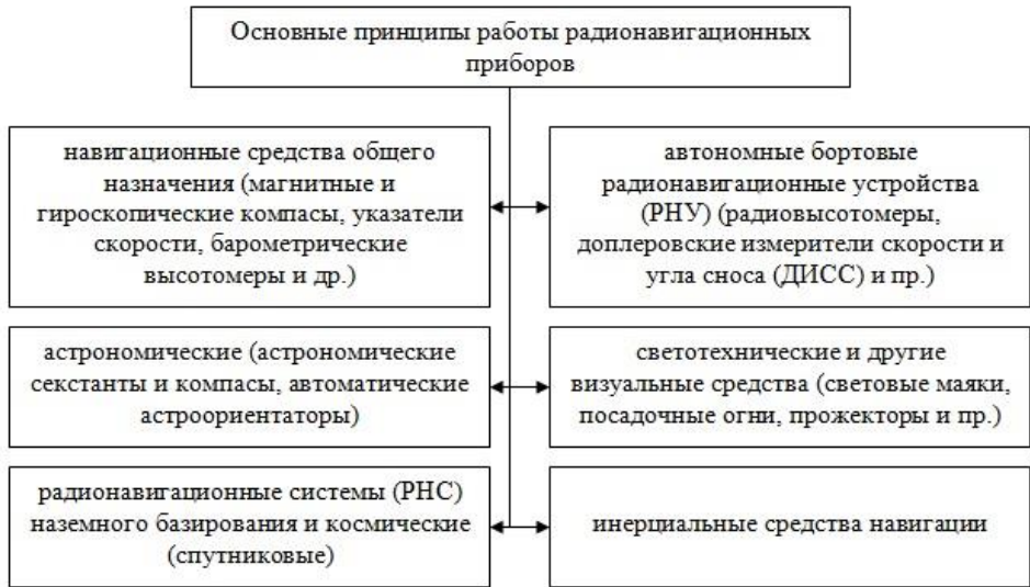
Рис. 1. Классификация радионавигационных приборов по основным принципам их работы
