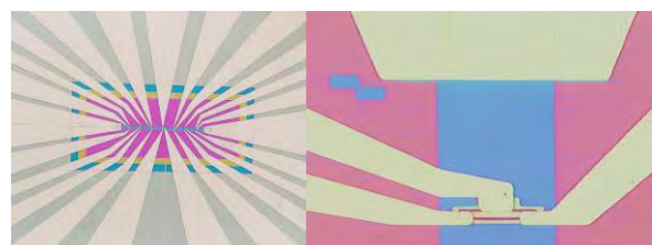
Рис. 2. Слева: изображение в оптическом микроскопе цепочки параллельных крестов Холла, литографированных на общем магнитном инжекторном слое, масштаб структуры легко определяется по длине CoFeB полоски, служащей магнитным инжектором (синяя полоска в центре, 700μм). Справа: фотография одиночного элемента, ширины CoFeB инжектора 22 μм
