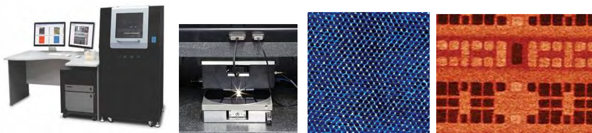
Рис. 7. Сканирующий зондовый микроскоп ВЕГА; 200 мм пластина, атомарное разрешение на НОРГ, размер скана 6x6 нм; поверхностный потенциал SRAM, размер скана 2,5x1,6 мкм; ( https://www.ntmdt-si.ru/products/automated-afm/vega )
