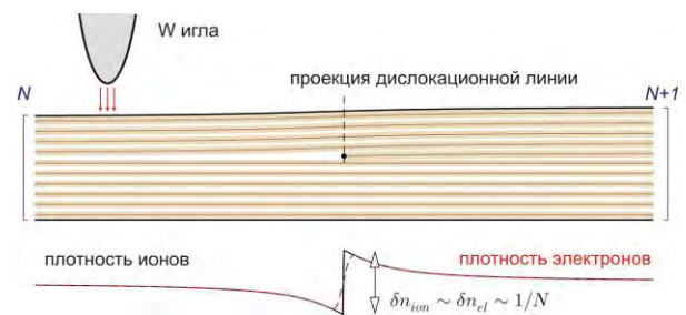
Рис. 1. Схематическое представление СТМ иглы, тонкой металлической плёнки с дислокационной линией и профилей объёмной плотности ионов (сплошная черная линия) и электронов (пунктирная красная линия)
