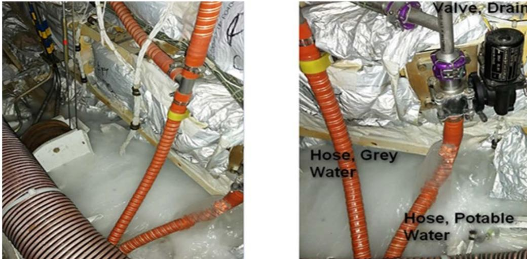
Рис. 2. Пример следствия примерзания водяной системы
