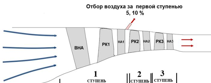
Рис. 1. Схема исследуемого трехступенчатого осевого компрессора
