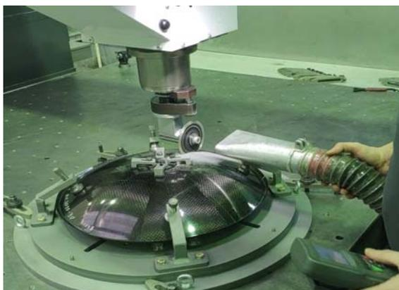
Рис. 4. Разрезка образца рефлектора  $\varnothing 0,5$  м, установленном в СТО, на портално-фрезерном обрабатывающем центре дисковой фрезой толщиной 1,2 мм
