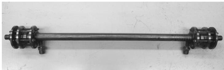
Рис. 2. Исследуемый участок № 1 (гладкая труба) и № 2 (труба с винтовой вставкой)
