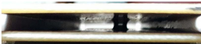
Рис. 2. Остаточные перемычки, оставшиеся после стекания воды
