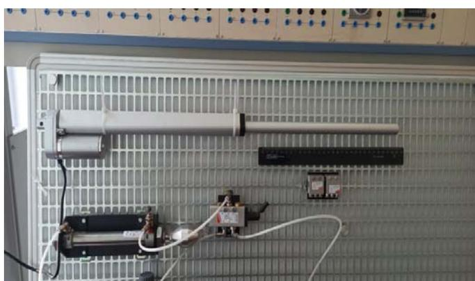
Рис. 1. Общий вид панели пневматической системы лабораторного стенда ГПС-01 с установленным разработанным электроприводом
