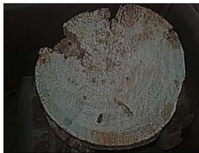
Рис. 1. Образец пораженной древесины
