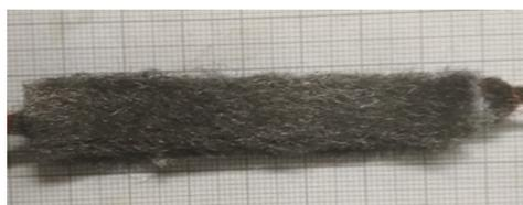
Рис. 1. Нагревательный элемент из КЭТМ и его микроструктура
