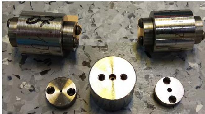
Рис. 3. Фиксирующее приспособление для дисперсионного старения высокоточных пружинных мелкогабаритных деталей типа цанг
