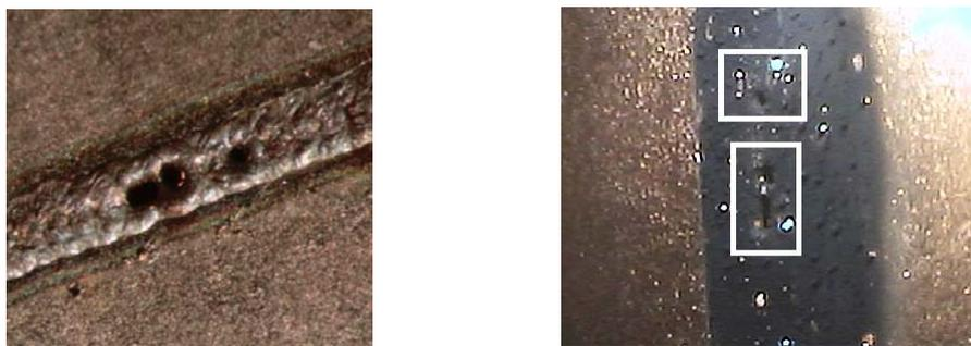
Рис. 1. Внешний вид прожогов заготовки ГВС наружный (левый) и внутренний вид (правый)
