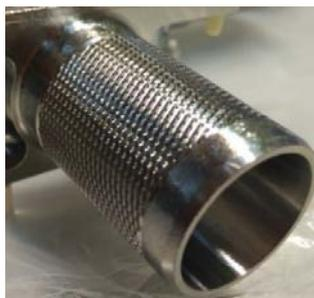
Рис. 4. Рифление, выполненное резанием на токарном станке
