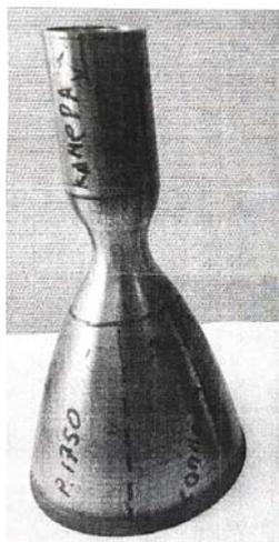
Разметка на камере-демонстраторе РДМТ
