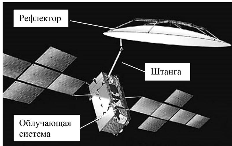
Рис. 1. КА «Eurosat» с рефлектором диаметром 12 метров
