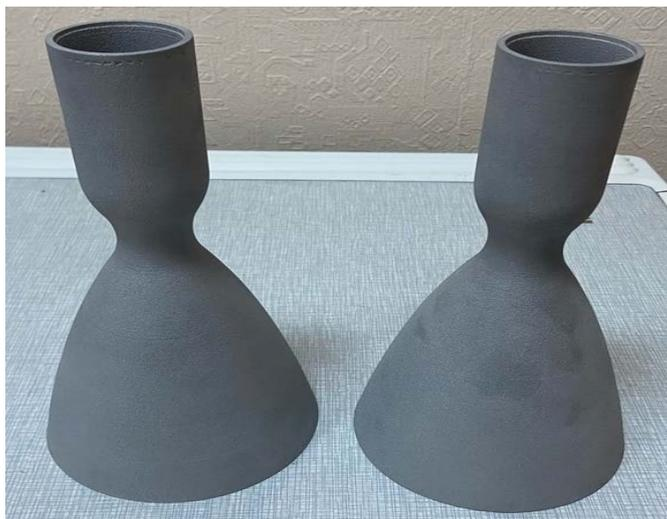
Рис. 3. Камеры ракетного двигателя, изготовленные на 3Д-принтере
