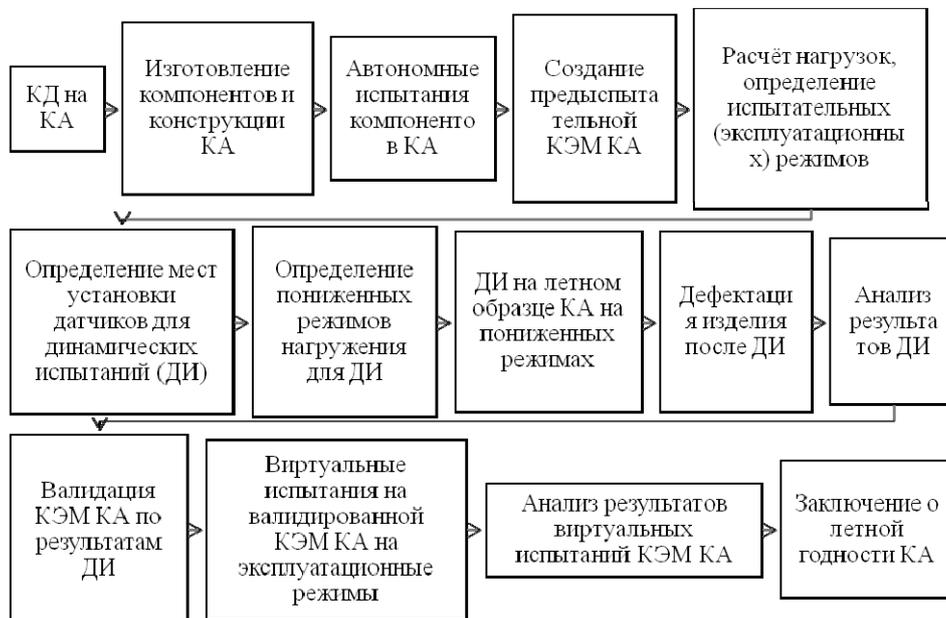
Расчётно-экспериментальный метод динамической (вибрационной) отработки КА
