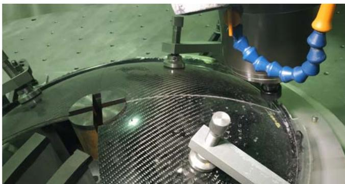
Рис. 3. Разрезка образца рефлектора  $\varnothing 0,5$  м, установленном в СТО, на портално-фрезерном обрабатывающем центре фрезой  $\varnothing 0,5$  мм
