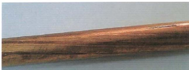
Рис. 2. Скручивание волокон прутка ДКРНТ БрБ2 ГОСТ15835-70 Ø8
