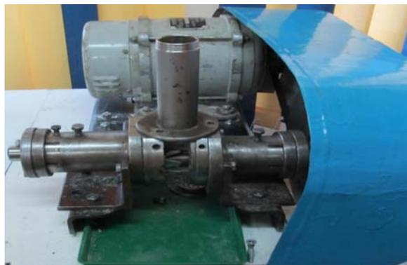
Рис. 1. Общий вид лабораторной установки для размола вермикулита МР – 5
