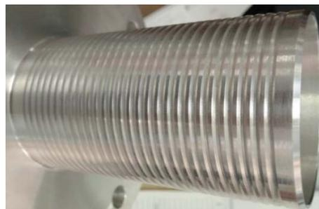
Рис. 5. Рифление, выполненное проточками на фрезерном станке
