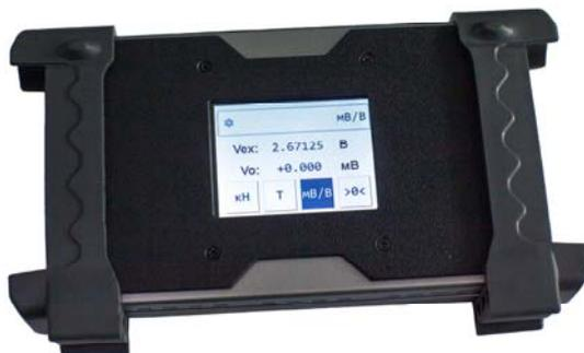
Рис. 2. Блок аналого-цифрового преобразования сигналов первичных измерительных преобразователей
