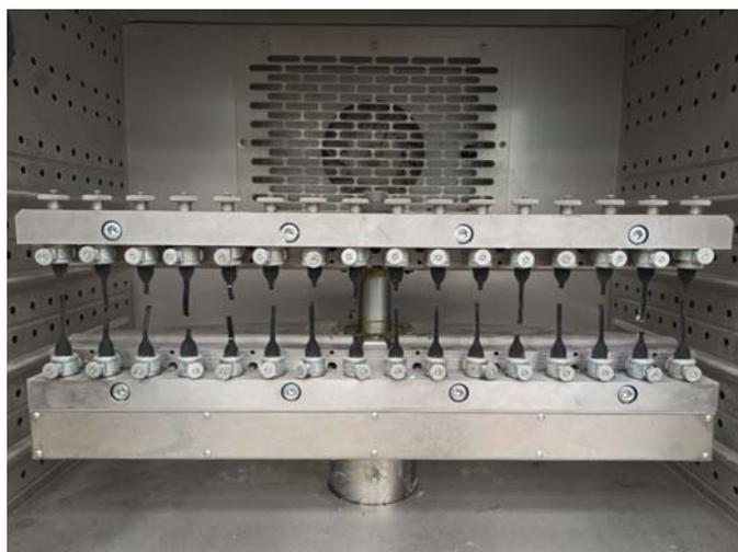
Образцы после циклических испытаний
