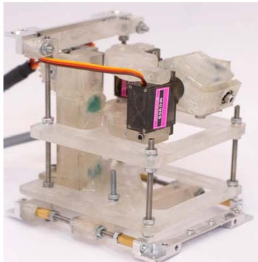
Рис. 1. Мехатронный и многостепенной модули в сборке
