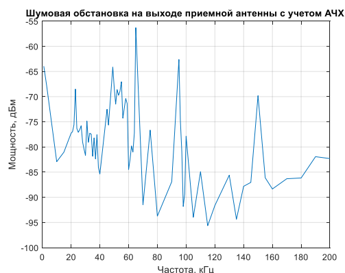
Рис. 6. Шумовая обстановка на выходе приемной антенны с учетом нормировки по АЧХ антенны
