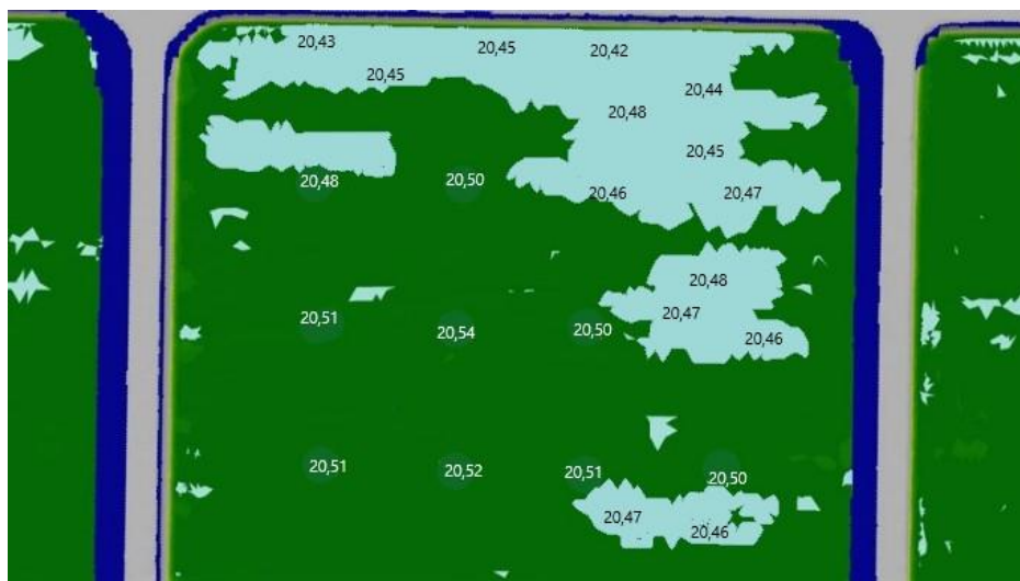
Рис. 6. Выноски остаточной толщины полотна «вафельного фона»
