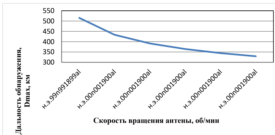
Рис. 1. График зависимости дальности обнаружения от скорости вращения антенны
