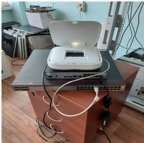
Рис. 7. Контроллер AC6508 и точка доступа AirEngine6760-X1
