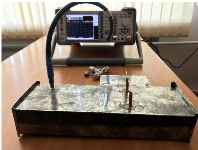
Рис. 5. Волноводно-дипольная антенна с подключенным измерителем
