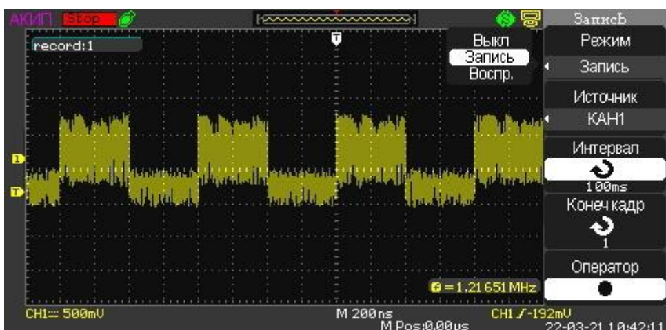
Рис. 8. Осциллограмма выходного напряжения при ОСШ 10 дБ
