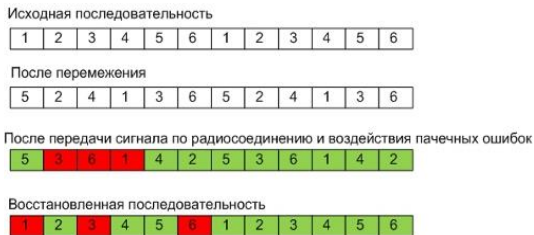
Рис. 2. Использование технологии перемежения для ликвидации пачек ошибок
