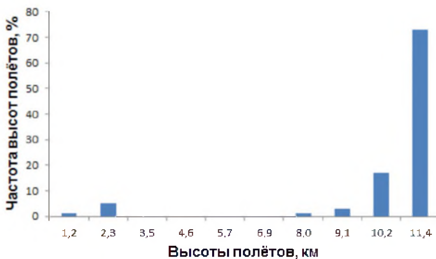
Рисунок 3.12 – Распределение высот полётов самолётов в радиусе 100 км от Томска 8–9.01.2018 г. по данным сайта [28]
