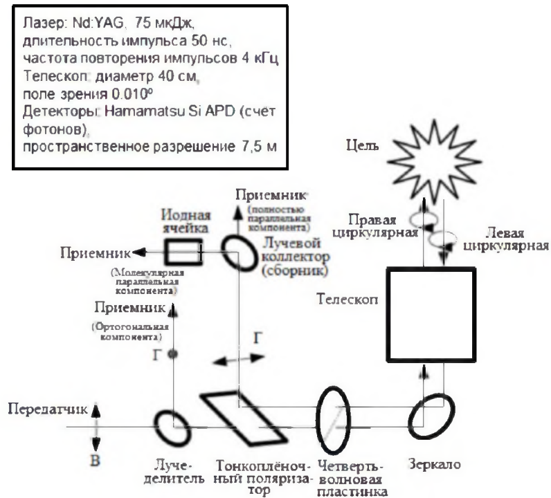
Рисунок 1.3 – Схема приёмопередатчика лидара с высоким спектральным разрешением (Национальный центр атмосферных исследований, США) [121]
