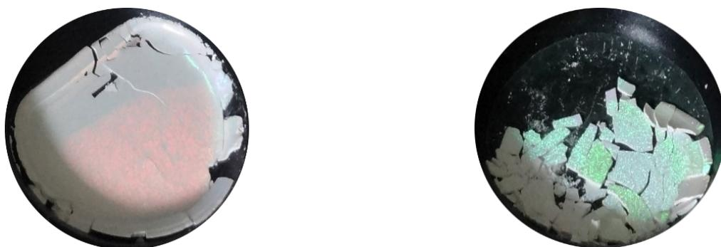
Рисунок 2.14 – Фотографии кюветы с выращенным в ней трёхмерным ПММА-опалом. Снимки сделаны под различными углами, что обеспечивает различные
