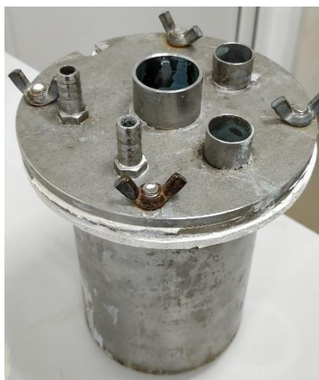
Рисунок 2.2 – Герметичный реактор из нержавеющей стали, представляющий собой пятигорлый цилиндр объёмом 1 л. На фото видны выходы для механической мешалки (по центру), датчиков цифрового термометра и зонда ИК-Фурье спектрометра (два фланца среднего диаметра) и продувки газообразным азотом (два штуцера наименьшего диаметра)
