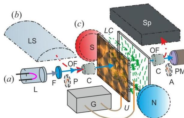
Рис. 2. Электрооптическая (а) и спектральная (b) экспериментальные схемы
