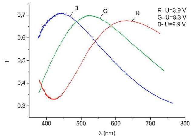
Рис. 7. Спектры пропускания для САНД при напряжениях смещения  $U$ : 3,9; 8,3; 9,9 V
