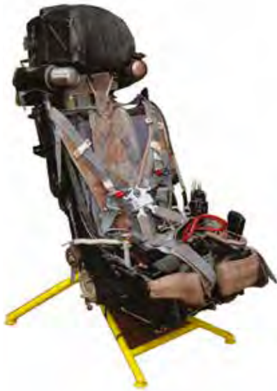
Фото 6. Штатное катапультное кресло воздушного судна
