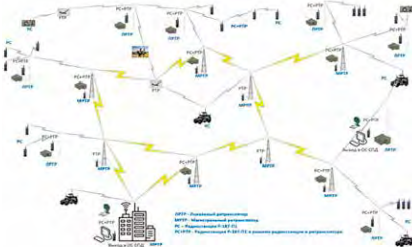
Рис. 2. Распределённая сеть связи на радиостанциях Р-187-П1
