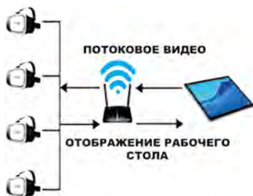
Фото 3. Структурная схема комплекса подготовки лётного состава с использованием технологий виртуальной и дополненной реальности
