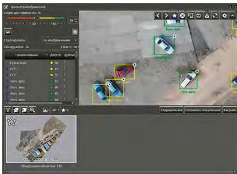
Рис. 4. Автоматическое распознавание объектов
