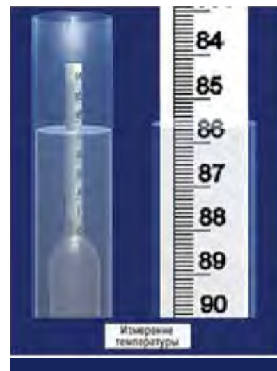
Рис. 6. Имитация определения крепости этилового спирта
