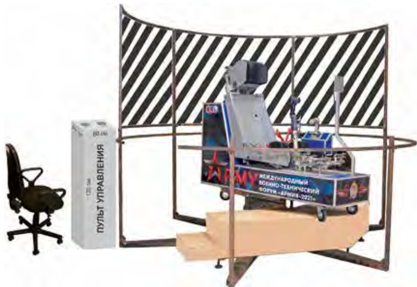
Фото 1. Установка для профессионального отбора лётного состава – динамический тренажёр для проведения вестибулярной и психофизиологической подготовки
