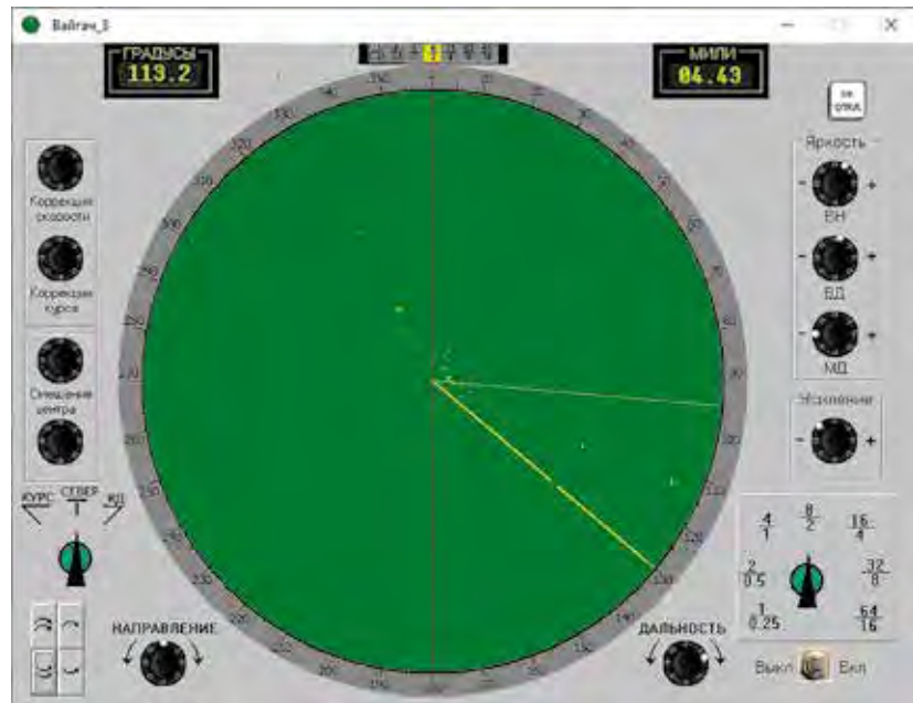
Рис. 4. Экранная форма виртуальной РЛС надводной обстановки
