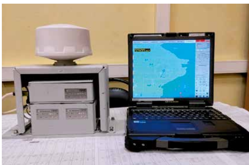
Фото 2. Автоматизированное рабочее место штурмана (АРМ-Ш)
