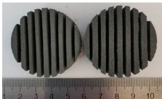
Рис. 2. Образцы СТТ, содержащие в качестве энергетической добавки 15 масс. % порошка алюминия
