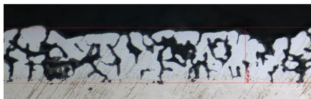
Рис. 1. Профили среза образца из нержавеющей стали с хромовым покрытием после экспериментов
