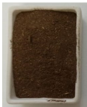
Рис. 1. Шлам биогазовой установки
