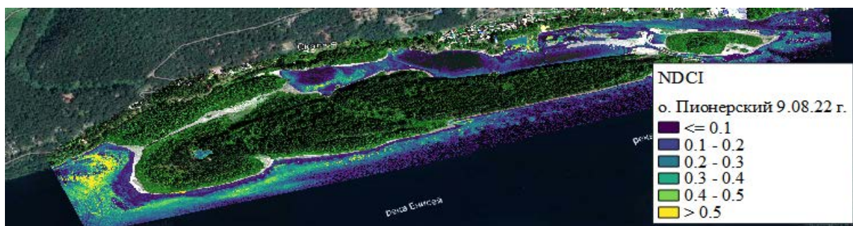
Рис. 1. Значения NDCI вокруг о. Пионерский за 9 августа 2022 года по данным мультиспектральной камеры MicaSense RedEdge-MX.
