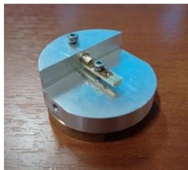
Рис. 1. Держатель образцов для растрового электронного микроскопа, позволяющий работать с образцом «на просвет»
