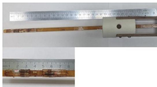
Рис. 1. Измерительный шток (вид сбоку) и изображение компенсационных датчиков
