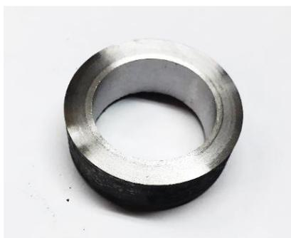
Рисунок 6 – Кольцо из материала сталь 20 ГОСТ 1050 с покрытием из композиции на основе алюминиевого сплава (75 % силумина АК12 + 25 % порошка свинца ПС1) для определения остаточных напряжений
