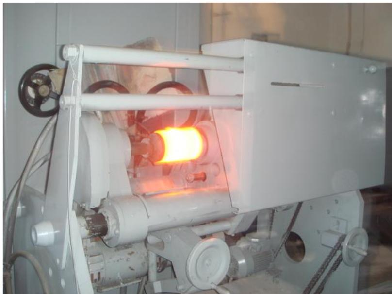
Рисунок 3 – Процесс изготовления биметаллическая заготовки втулки подбивочного блока выправочно-подбивочно-рихтовочной
