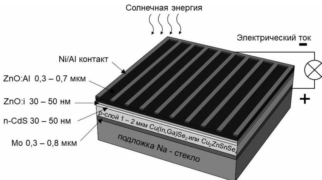
Рисунок 1 – Гетероструктура солнечного элемента на основе тонких пленок твердых растворов  $\text{Cu}(\text{In,Ga})\text{Se}_2$  или соединения  $\text{Cu}_2\text{ZnSnSe}_4$
