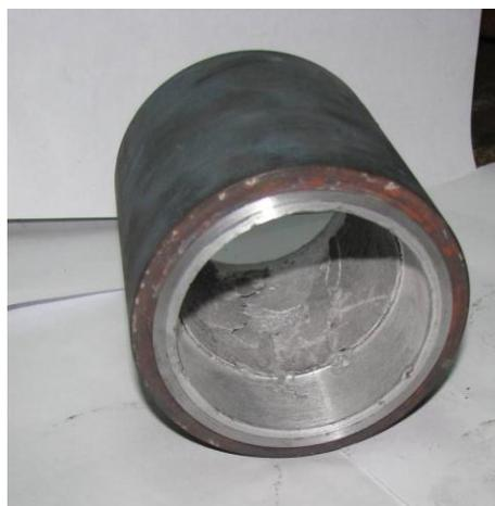
Рисунок 4 – Биметаллическая заготовка втулки № 90.31.00.062 подбивочного блока выправочно-подбивочно-рихтовочной машины ВПР номенклатуры ЭРУП «Центр механизации путевых работ Бел.ж.д.» с покрытием из силумина АК12, подслой – порошок свинца ПС1
