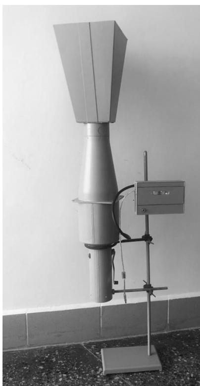
Рисунок 5 – Установка для тестирования датчика влажности зерна в поточном режиме
