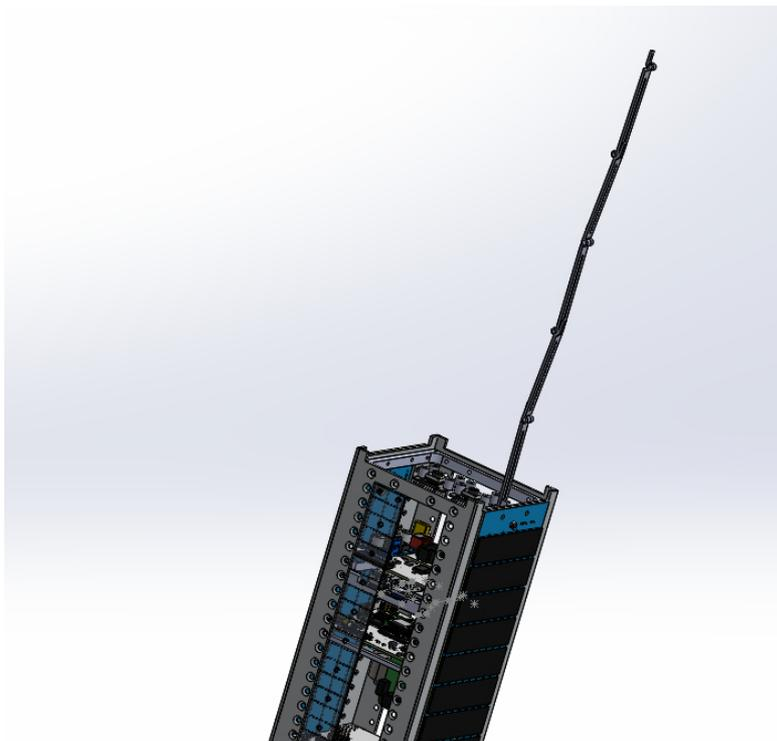
Рис. 2. Моделирование раскрытия штанги магнитометра
