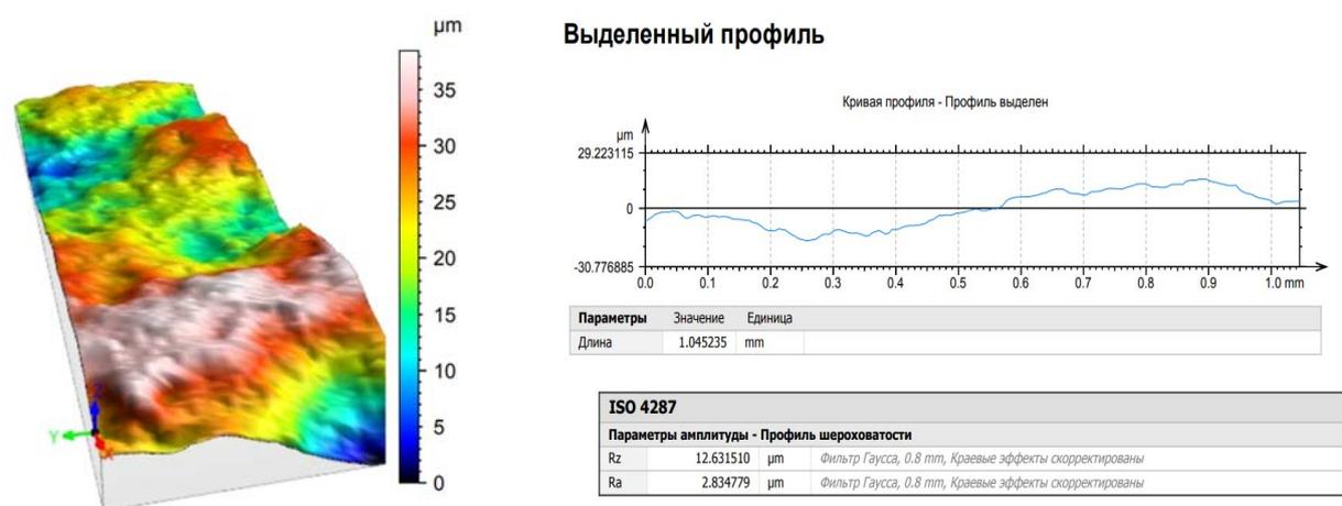
Рис. 2. Топография обработанной поверхности
