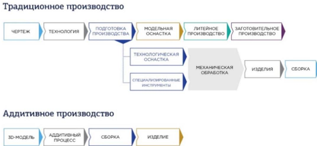
Рис. 1. Схема традиционного и аддитивного производства.
