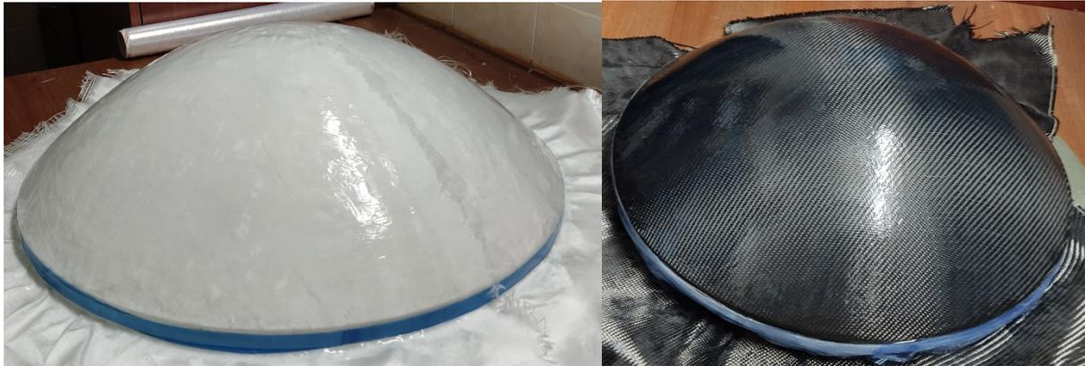
Рис. 1. Формование мембранных отражателей на оснастке
