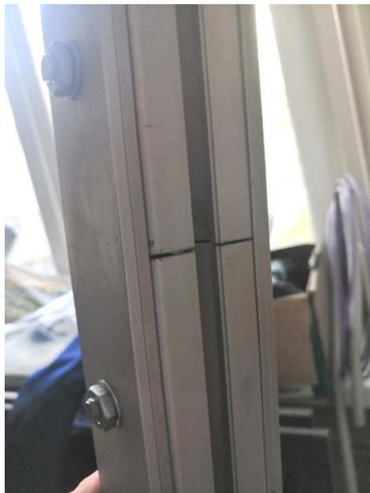
Рис. 3. Зазор на стыке направляющей
