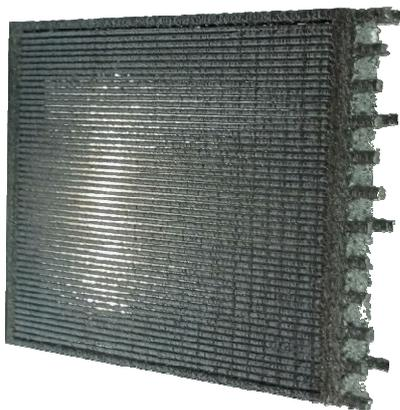
Рис. 1. Напечатанный образец микропористого металла
