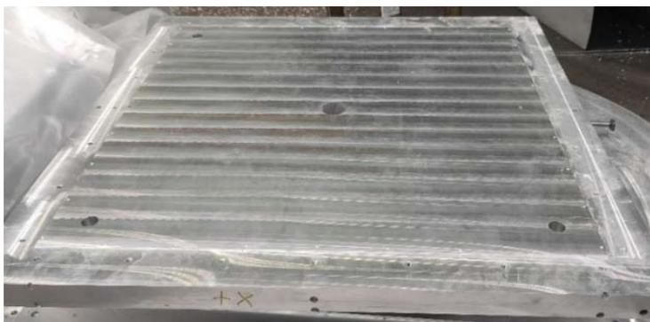
Рис. 2. Специальное приспособление для механической обработки заготовки
