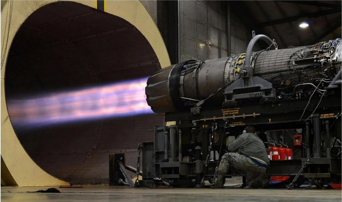
Рис. 1. Испытательный стенд реактивных двигателей Rolls-Royce
