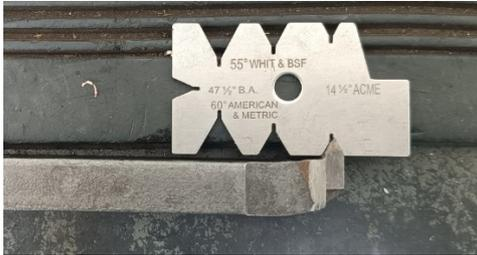
Рис. 1. Угол подъема резца
