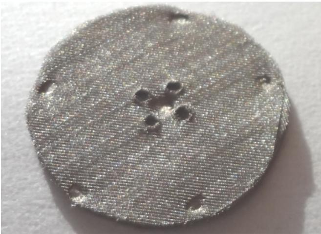
Рис. 2. Изображение одной из заготовок многослойного капиллярно-пористого испарителя ТТ с размером ячеек 0.04 мм. Хорошо видны четыре инжекторных канала диаметром 1 мм для выхода и формирования струй пара, пронизывающих насквозь круглые заготовки по 10 слоев сетки в каждой
