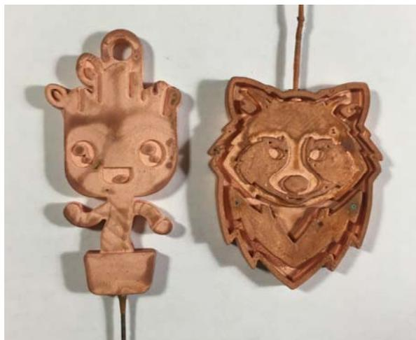
Рис. 2. Меднение с нагревом электролита
