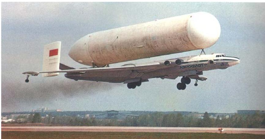
Рис. 2. Транспортировка деталей «Энергии» с помощью самолета МЗ
