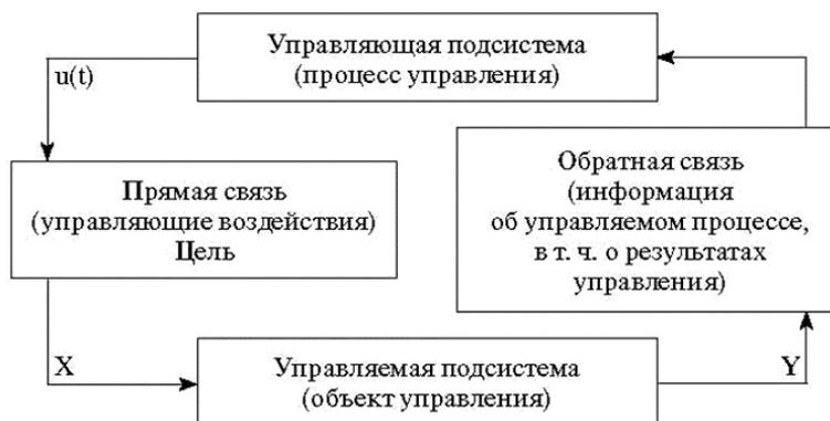
Рис. 1 Принципиальная схема структуры системы управления
