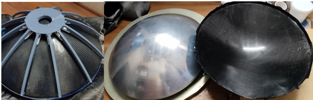
Рис. 2. Крепление спиц к мембранному отражателю на пентэласт и снятие с оснастки
