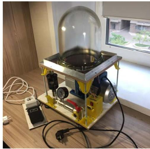
Рис. 2. Вибро-вакуумная установка
