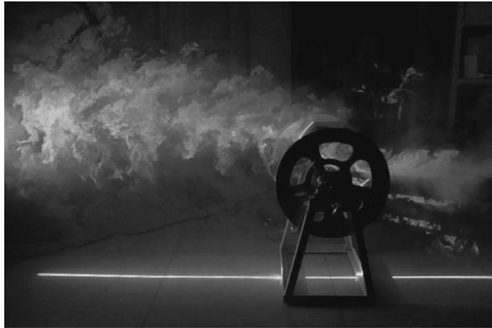
Рис. 1. Визуализация потока, формируемого циклическим движителем
