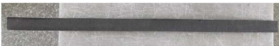
Рис. 2. Пример полученного 4х слойного углетканного стержня
