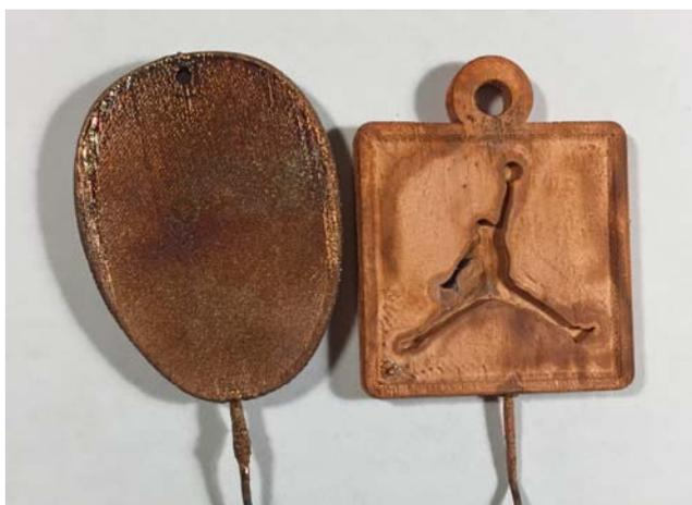
Рис. 1. Меднение без нагрева электролита
