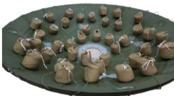
Рисунок 3 – Испытания на воздействие эквивалентной ветровой нагрузки
