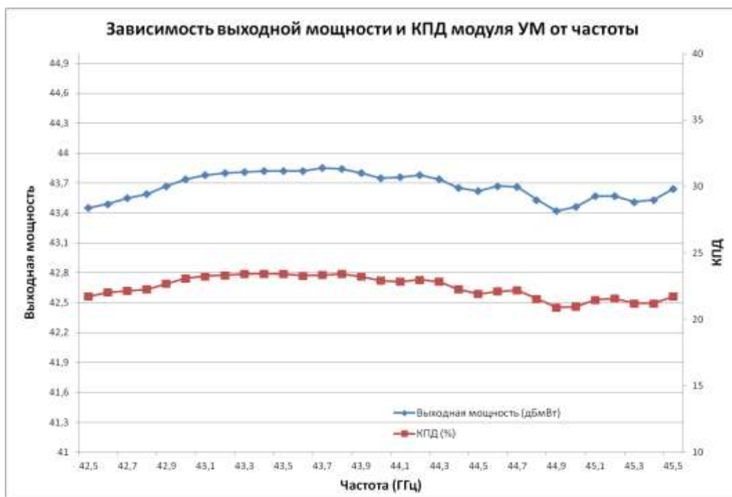
Рис. 2 – результаты измерения КПД и выходной мощности модуля УМ после улучшения согласования МИС с СВЧ полосковыми линиями
