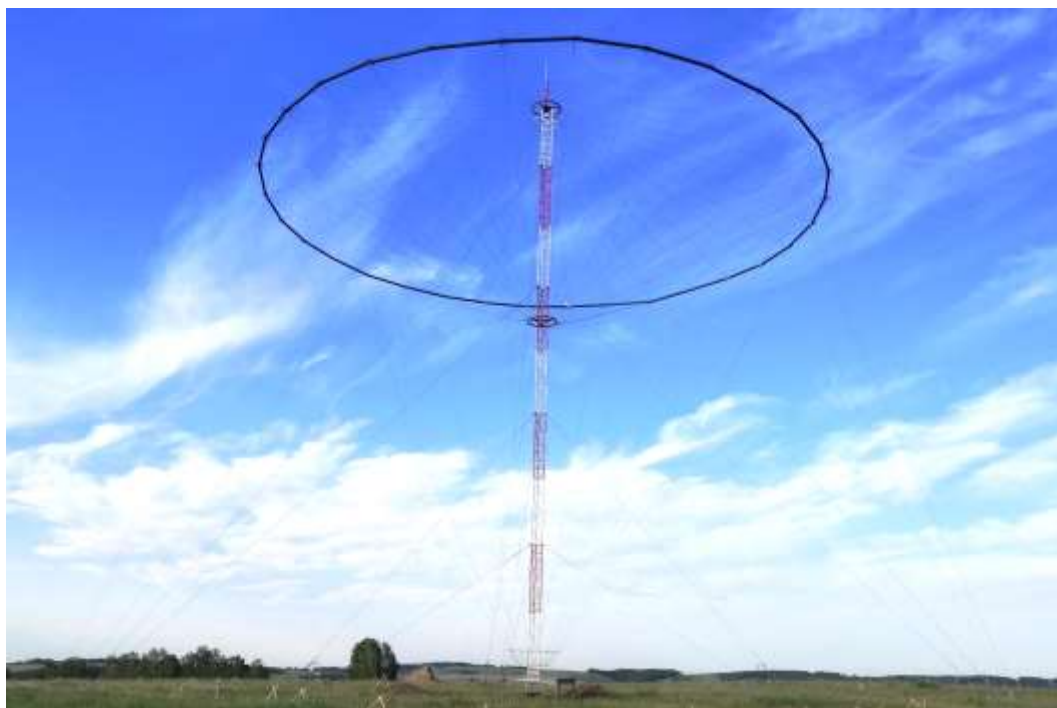
Рисунок 2. Моноконическая антенна на измерительном полигоне
