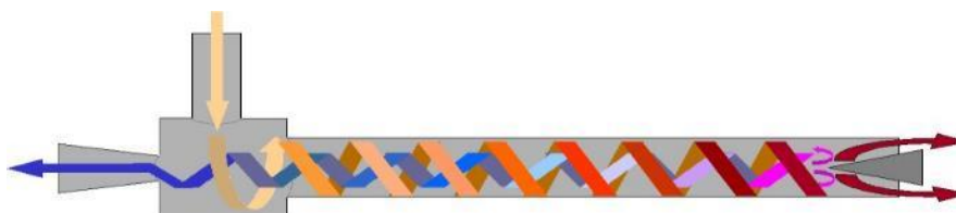
Рисунок 2. Разделение потоков в вихревой трубке.
