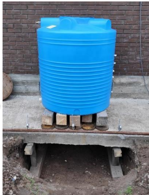
Рисунок 1. Чертеж и общий вид испытания плиты отмостки (первое испытание)
