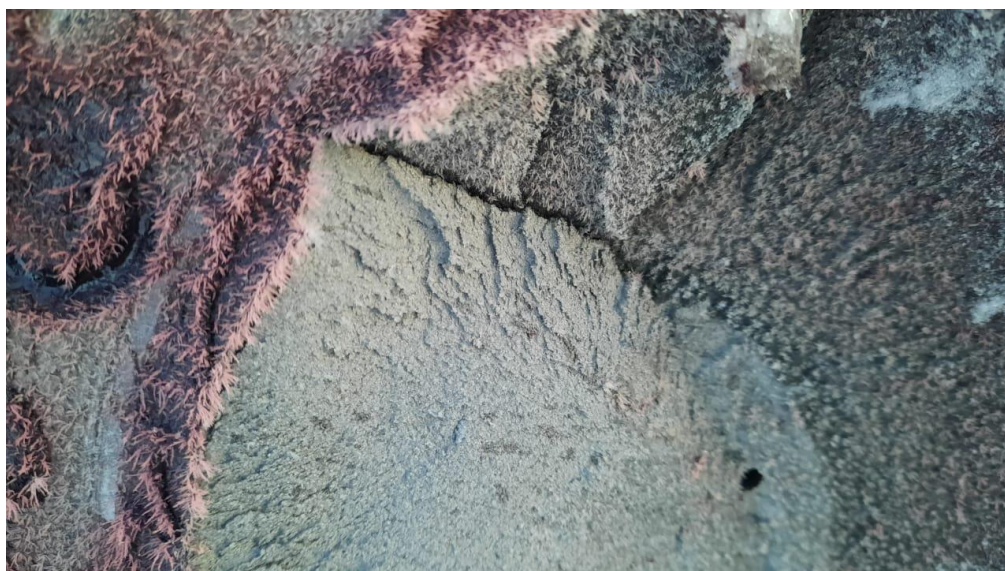
Рисунок. Фрактограмма хрупкого рывчатого излома образца стали
