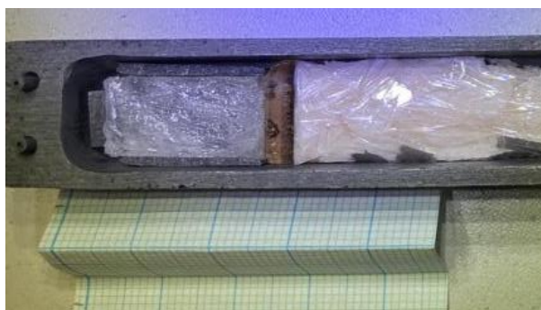
Рисунок 3. Монокристалл тетрабората европия, выращенный на монокристаллической затравке тетрабората стронция
