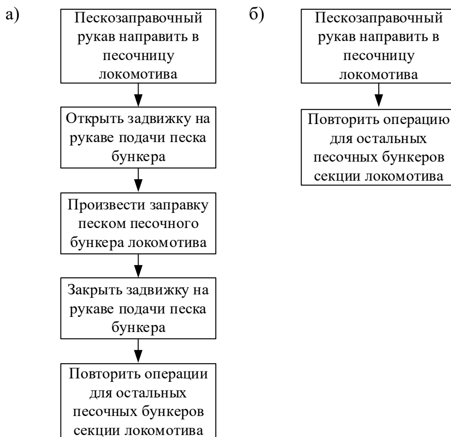
Рисунок 2. Технологический процесс заправки локомотива песком экипировщиком а) в настоящее время; б) при внедрение предлагаемого технического решения
