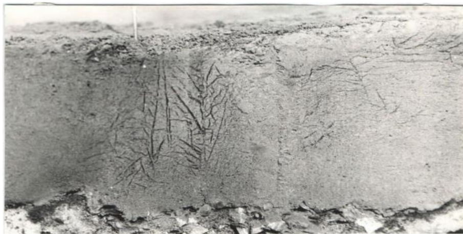
Рисунок 2. Наклонные линзы льда на стыке обработанного и необработанного грунта
