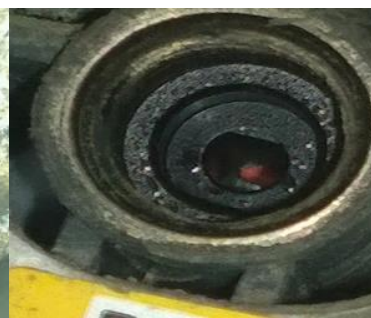
Рисунок 3. Вода в блоке клапанов
