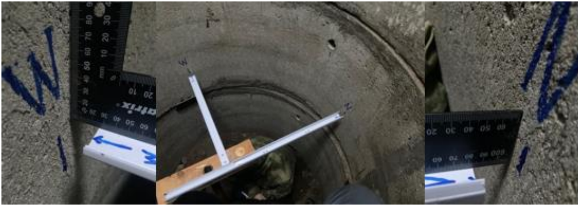
Рисунок 4. Процесс измерения зазора
