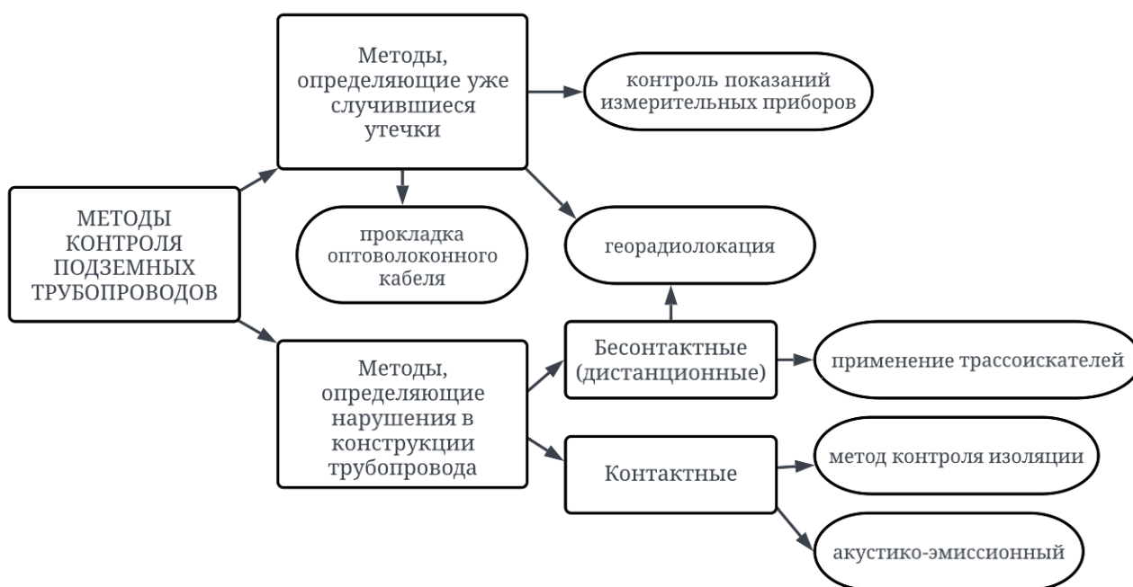
Рисунок. Классификация методов контроля подземных трубопроводов
