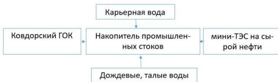
Рисунок 1. Принципиальная схема движения сточных вод ГОК.
