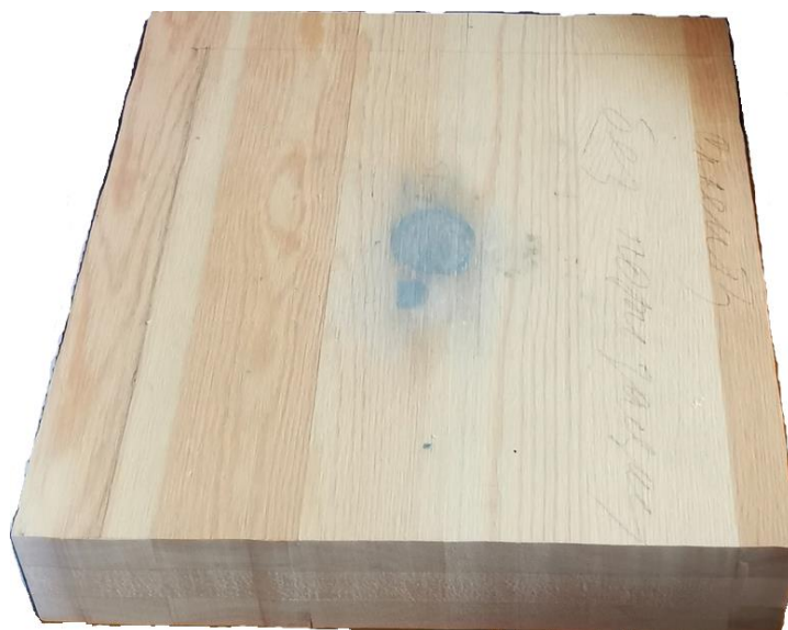
Рисунок. Образец для расчёта размерами 250x250x53 мм
