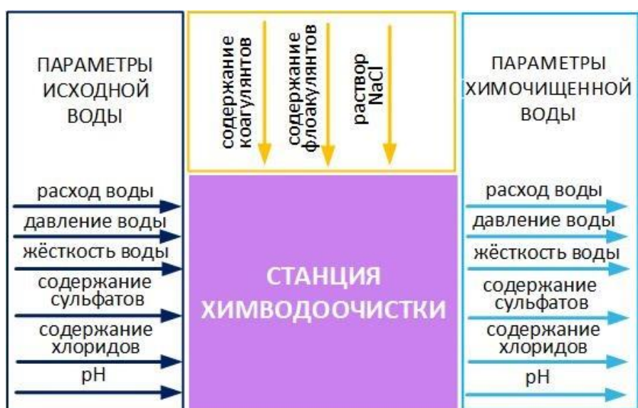
Рисунок. Станция химводоочистки как объект автоматизации.
