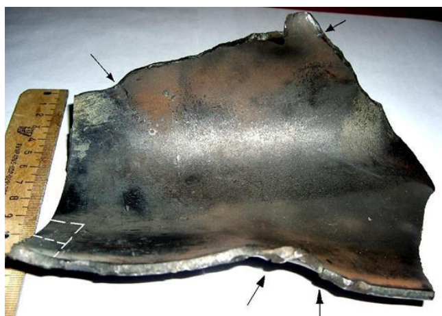
Рисунок 1. Общий вид фрагмента разрушившейся листовой детали камеры сгорания с указанием мест вырезки образцов для металлографических исследований. Стрелками указаны трещины.
