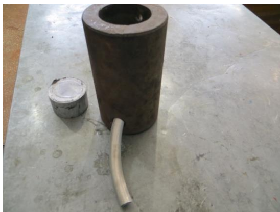
Рисунок 1. Контейнер, прессованный пруток и пресс – остаток
