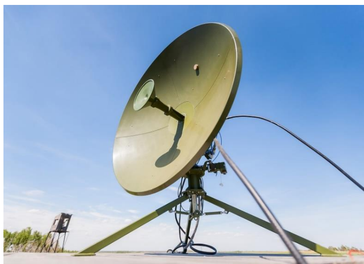
Рисунок 1. Цифровая станция тропосферной связи нового поколения «ГРОЗА»
