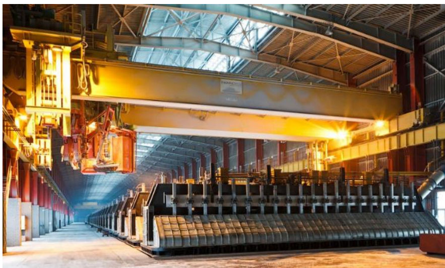
Рисунок 1. Внешний вид специального анодного крана над электролизерами
