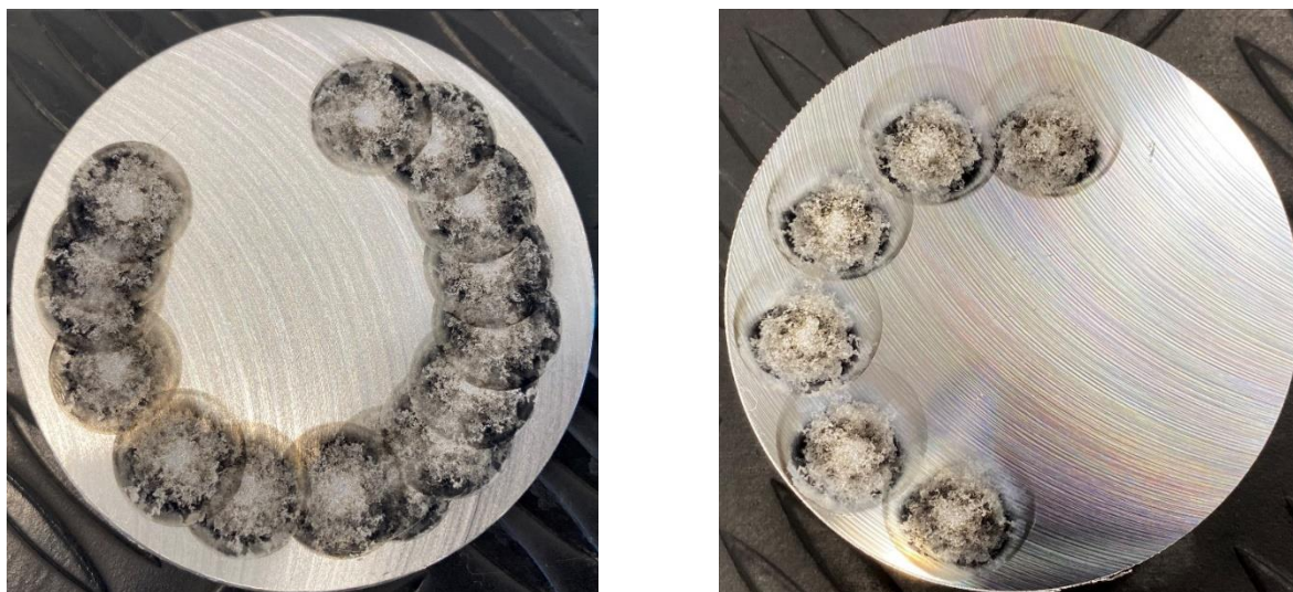
Рисунок. Схема прожигов при ОК: а – ручной режим (ARL 8820), б – автоматический режим (ARL QuantoShelter)
