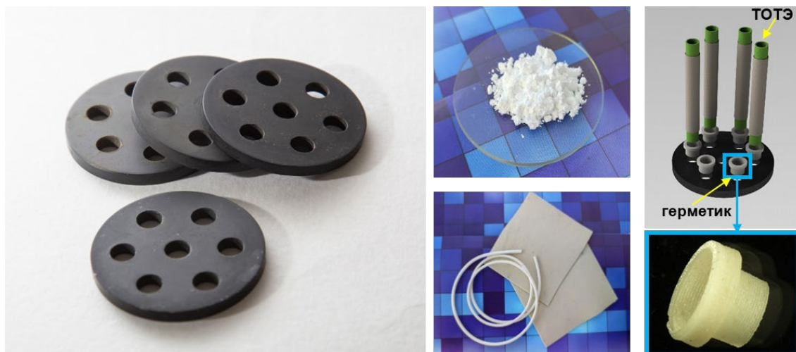
Рис. 1. Интерконнекторы и стеклогерметики для коммутации трубчатых ТОТЭ
