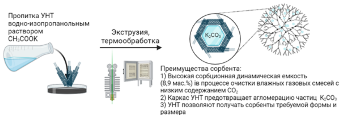
Рис. 1. Схема синтеза и преимущества сорбента \text{K}_2\text{CO}_3/\text{УНТ} .
