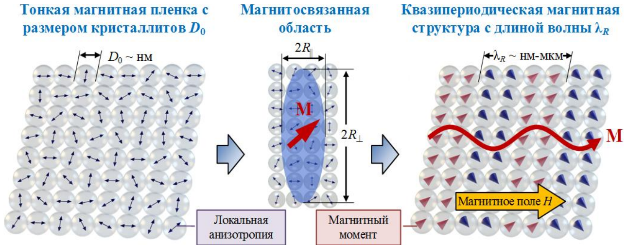
Рисунок 3 – Схематическая иллюстрация формирования квазипериодической магнитной структуры в нанокристаллической тонкой магнитной пленке
