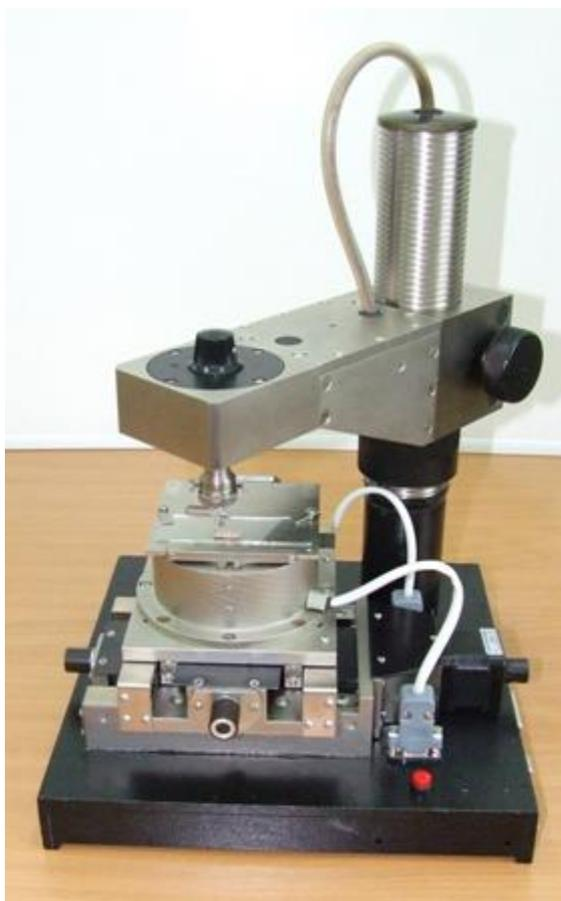
Рисунок 6.1 – Общий вид конструкции автоматизированного координатографа, предназначенного для формирования заданной текстуры на поверхности подложки
