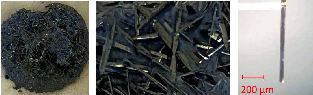
Рисунок 2.1 а) Друза монокристаллов \text{Co}_3\text{VO}_5 на поверхности раствора-расплава. б) Произвольно ориентированные между собой иголки в растворе-расплаве. в) Линейные размеры единичной иголки вдоль c -оси.
