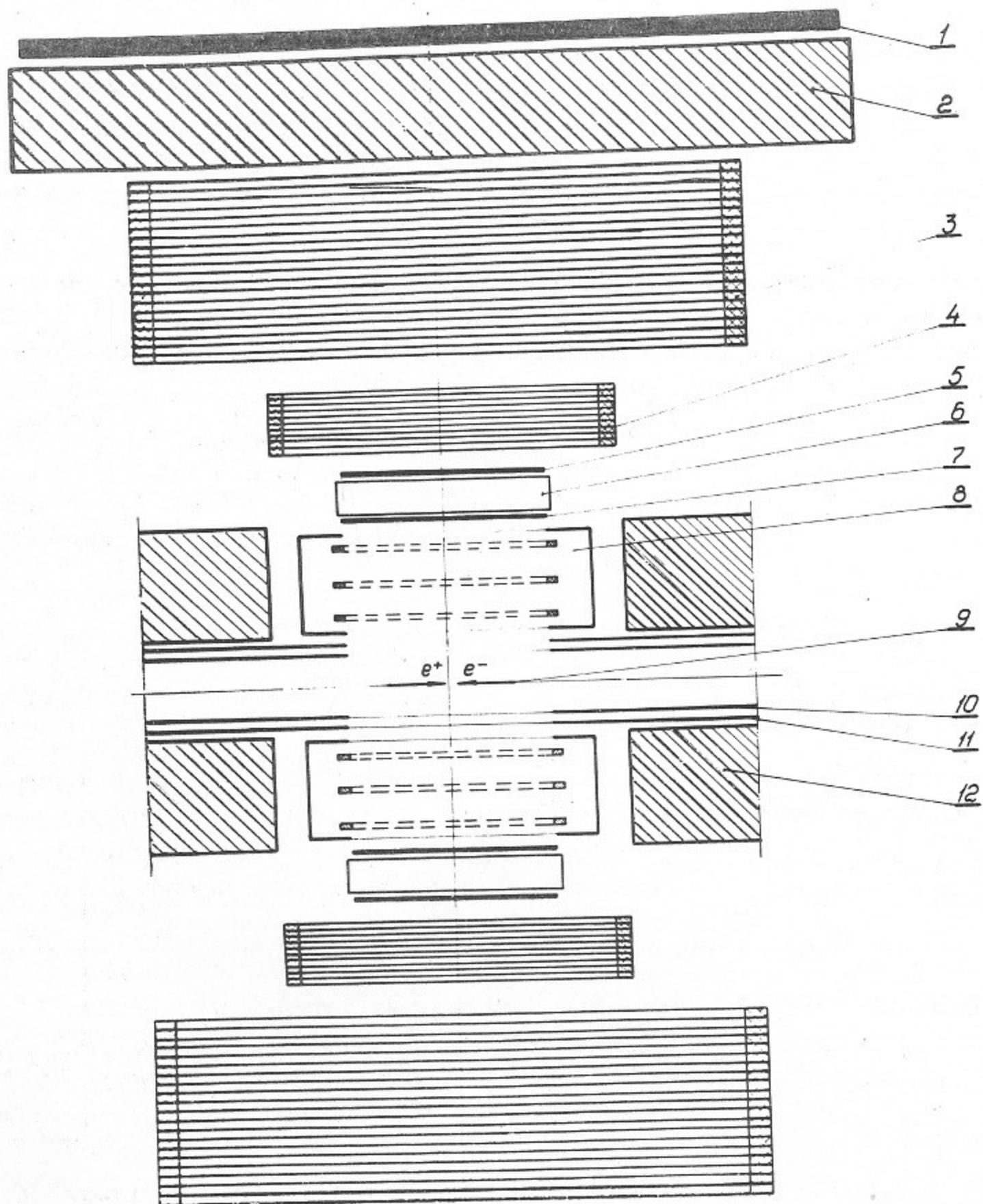
Рис.1. Система регистрации: 1-сцинтилляционный счетчик антисовпадений; 2-свинец; 3-пробежная искровая камера; 4-ливневая искровая камера; 5,7-сцинтилляционные счетчики; 6-водяной черенковский счетчик; 8-координатные проволочные искровые камеры; 9-область встречи; 10,11-внутренняя и наружная вакуумная камеры; 12-магнит накопителя.
