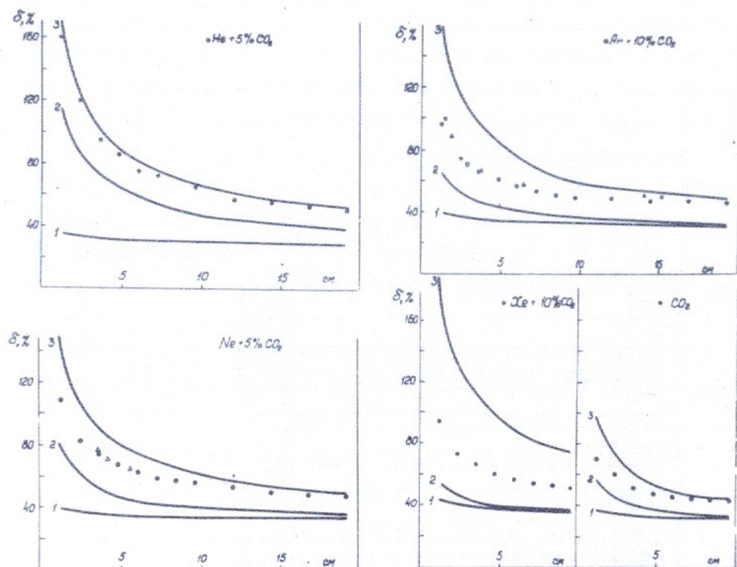
Рис.2. Амплитудное разрешение пропорциональных камер в зависимости от толщины и газа. По оси ординат отложено отношение ширины на полувысоте амплитудного распределения к наивероятной амплитуде. Экспериментальные данные:  $\Delta$  - /17/,  $X$  - /18/,  $\circ$  - /20/,  $\bullet$  - настоящая работа. Кривые - результаты расчета по теории Ландау:
