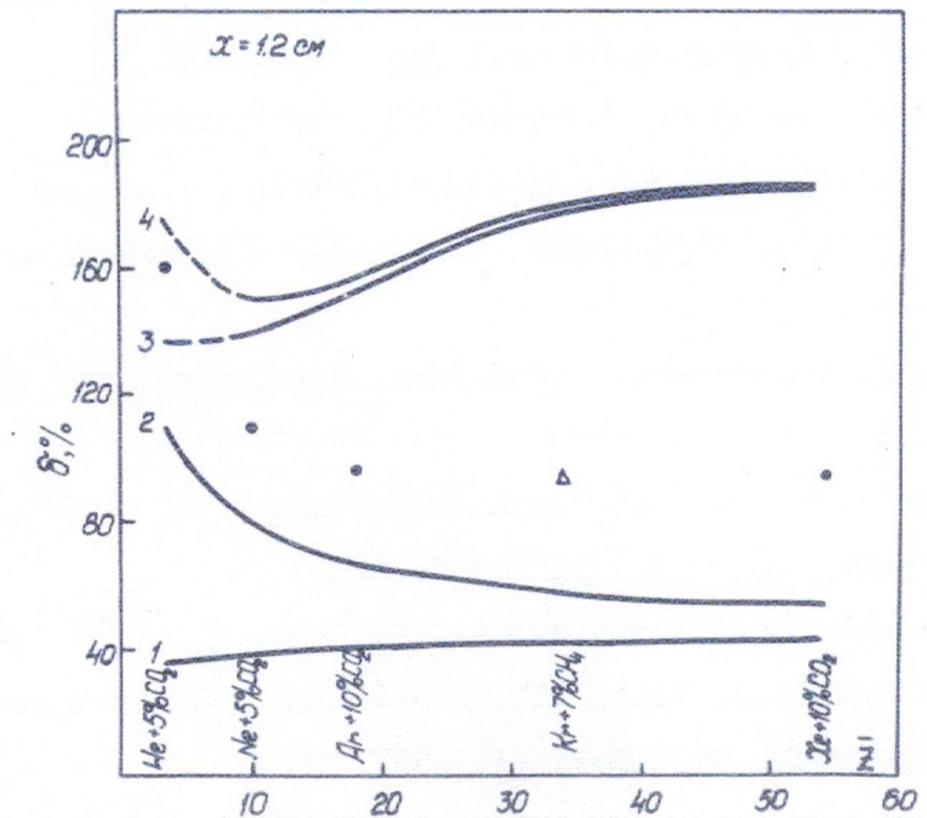
Рис.3. Амплитудное разрешение пропорциональной камеры толщиной 1,2 см в зависимости от атомного номера газа. Результаты измерений:  $\Delta$  - /17/,  $\bullet$  - настоящая работа. Кривые - расчет по теории Ландау: I - без учета собственного разрешения камер; 2 - с учетом собственного разрешения; 3 - с поправками Блунка-Лайзеганга; 4 - с поправками Б.Л. и учетом собственного разрешения камер.
