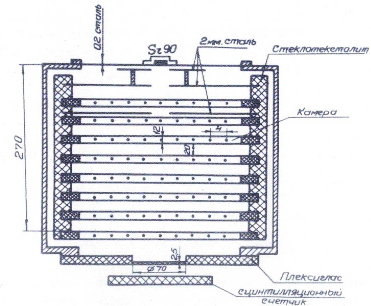
Рис. I. Схема расположения камер.
