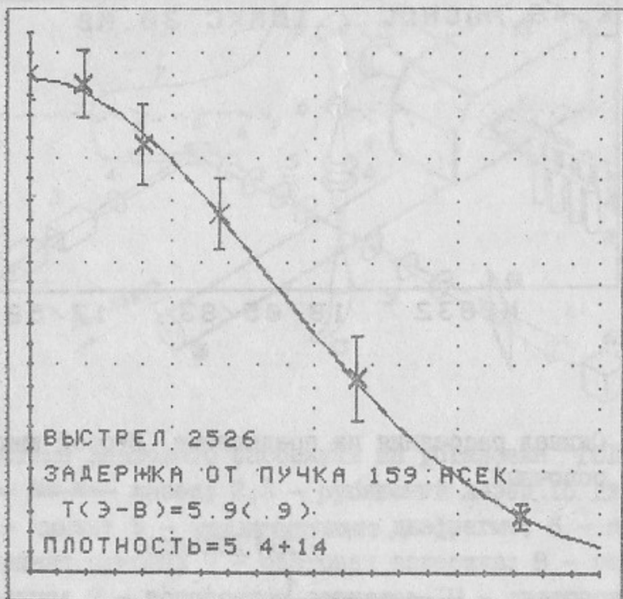
Рис.4. Спектр томсоновского рассеяния и результат его обработки, полученные в одном из экспериментов по взаимодействию РЭП с плазмой.
