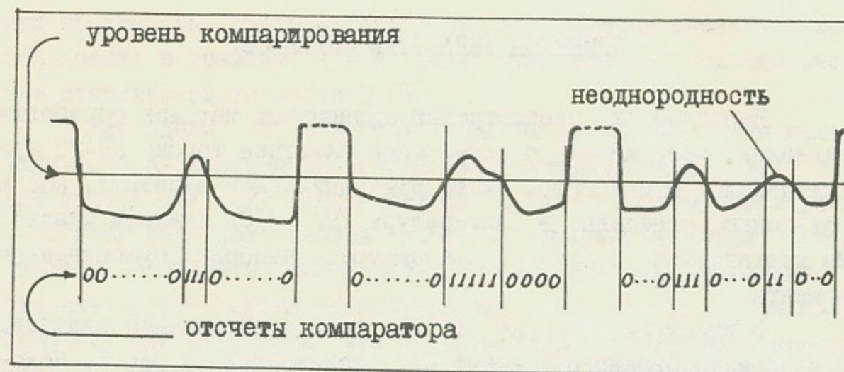
Рис.6. Способ обработки сигнала с сигнальной пластиной.
