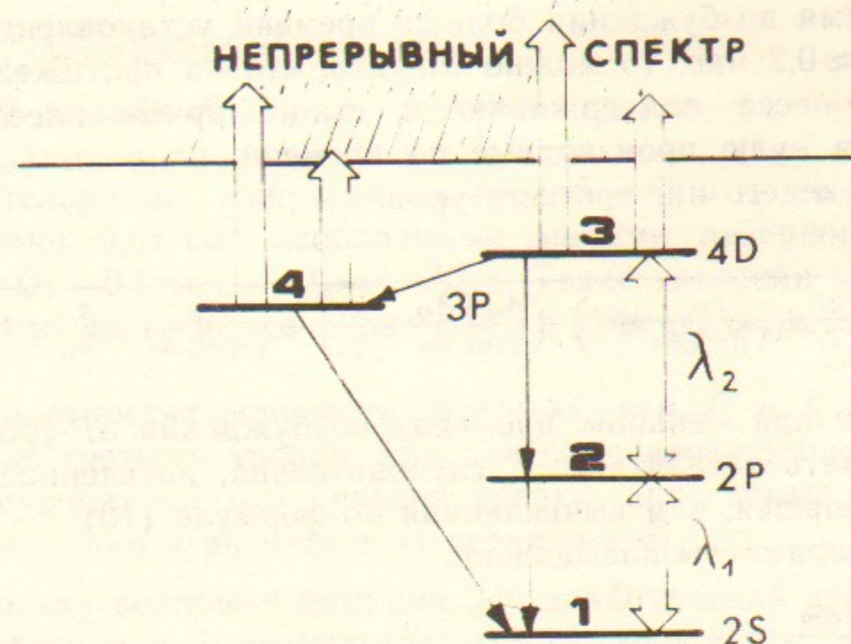
Рис. 5. Схема возбуждения 4D-уровня атома лития. Широкие стрелки соответствуют вынужденному излучению, тонкие — спонтанному.
