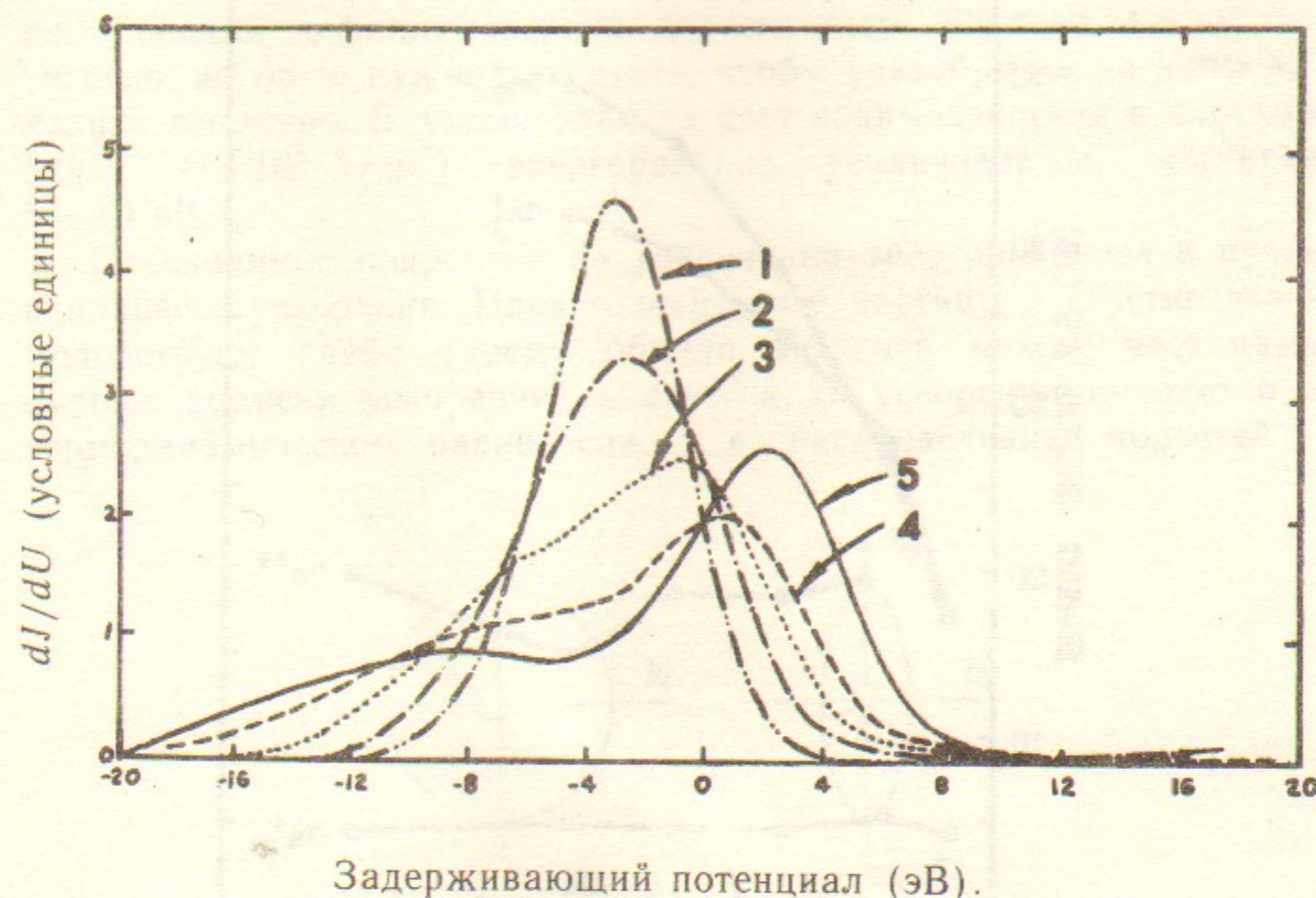
Рис. 5. Изменение распределения ионов \text{Ga}^+ по энергии в зависимости от температуры: T(\text{K}) = 295 (1); 375 (2); 412 (3); 560 (4); 900 (5); J_+ = 2,0 мкА.
