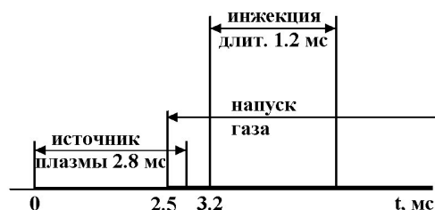
Рис.2. Сценарий эксперимента с осевой инжекцией молекулярного водорода.
