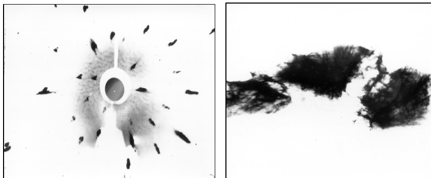
Рис. 9. Образец R-100. Усиление степени пластической деформации (а и б). Схематическое изображение «сброса» в алмазе (б и в), (по Мокиевскому).
